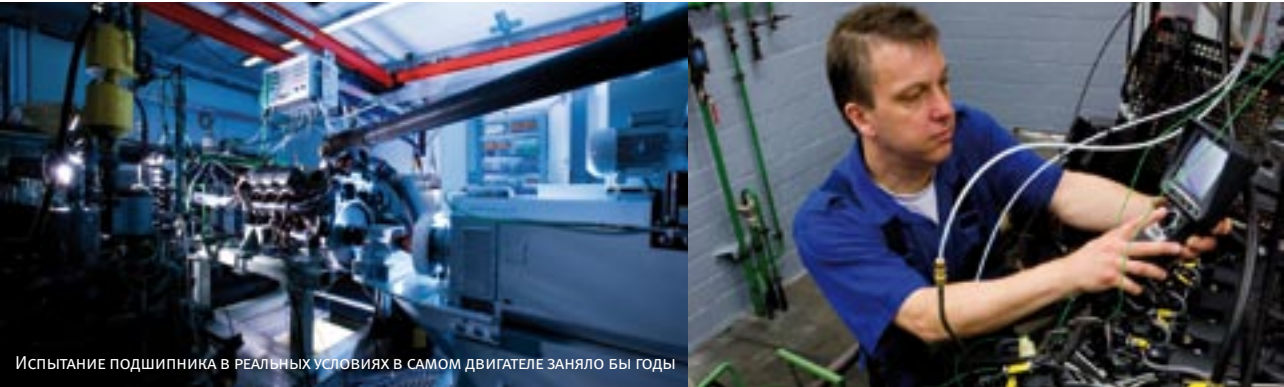
Проверяются деформации и напряжения в шатуне
