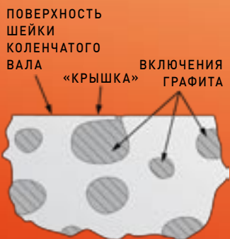
[РИС. 17] ПОВЕРХНОСТЬ «КРЫШЕК» ВКРАПЛЕНИЙ ГРАФИТА НА КОЛЕНЧАТОМ ВАЛЕ
