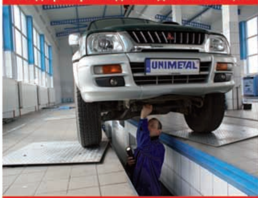
Стенд проверки подвески до и свыше 3,5 т.
