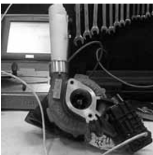
На стенде подключена турбина Garrett GT20 52V с клапаном с электронным управлением (ЭБУ Hella-Garrett) (используется, в том числе, на новых автомобилях Ford Connect 1.8l).
