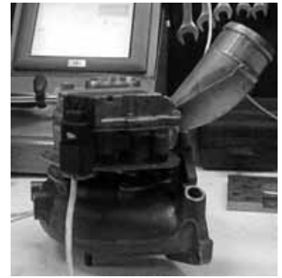
На стенде подключена турбина KKK BV50 с клапаном с электронным управлением (ЭБУ Siemens VDO) (используется на автомобилях Volkswagen T5).
