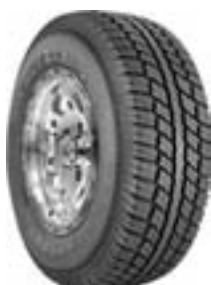
Cooper Discoverer ATR Всесезонная шина. Протектор: город/offroad – 70/30. Посадочные диаметры: 14-20
