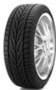
Fuzion ZRi Летняя шина, направленный рисунок протектора. Посадочные диаметры: 15-20
