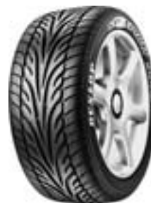
Dunlop SP SPORT 9000 Летняя спортивная шина с направленным рисунком протектора Посадочные диаметры: 14-22
