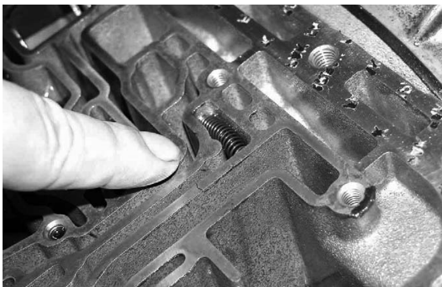
Эта сложная система каналов и есть гидравлическая распределительная система, или «лабиринт» (АКП А4LD автомобиля Ford Explorer)
