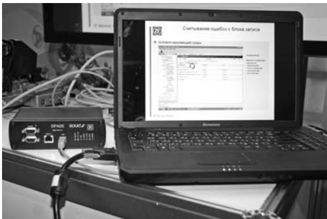
Диагностический прибор Testman предназначен для тестирования всех автоматических коробок передач производства ZF, а в скором будущем - и всех элементов активной подвески.
