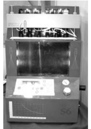
Стенд оснащён встроенной системой «Антиудар», предохраняющий посадочное место клапана форсунки от расклепывания, обеспечивая очень мягкую посадку иглы клапана форсунки. Широкие возможности диагностики позволяют имитировать работу двигателя, установить и оценить текущее состояние форсунок. Оборудование сертифицировано в Украине. Гарантия 12 месяцев.
