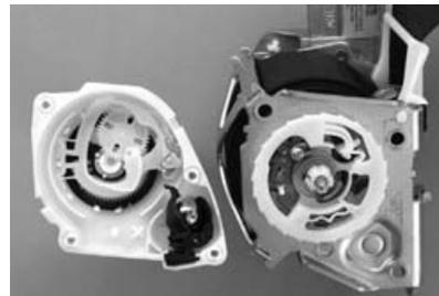
Однако инженеры корпорации TRW исправили ситуацию, создав конструкцию самонастраивающегося ремня SelfAdaptive Load Limiter (SALL), которая имеет самоадаптирующийся механизм. Принцип его работы достаточно прост и основан на длине ремня. Эта система имеет два рабочих уровня: легких пассажиров она держит слабо, а тяжелых - максимально жестко. Эта технология разработана для пассажиров, которые садятся на заднее сиденье, и уже применяется в автомобилях последнего поколения Mercedes-Benz E-класса.
