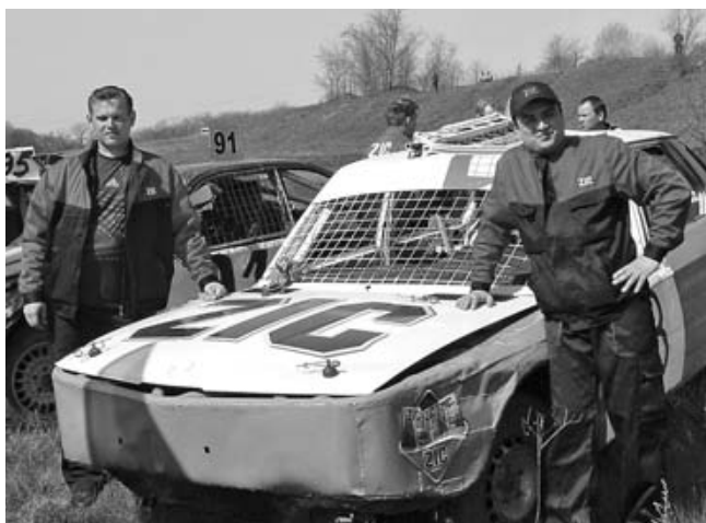
Автомобили гонщиков укреплены специальным каркасом из труб, который должен обеспечить безопасность гонщику и не дать развалиться машине от удара соперника.
