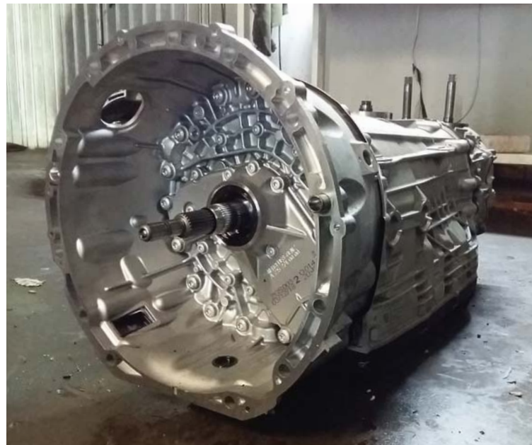
На фото: новейшая АКП Mercedes-Benz 9G-Tronic, приобретенная в качестве научного пособия для повышения уровня квалификации сотрудников.
