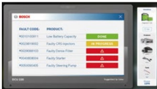
Коди помилок — відображаються на віртуальному DCU 220
