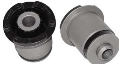
Сайлентблок подрамника, усиленный, серии BAD ROADS. Артикул BC1103. Nissan, Opel, Renault, Vauxhall.
