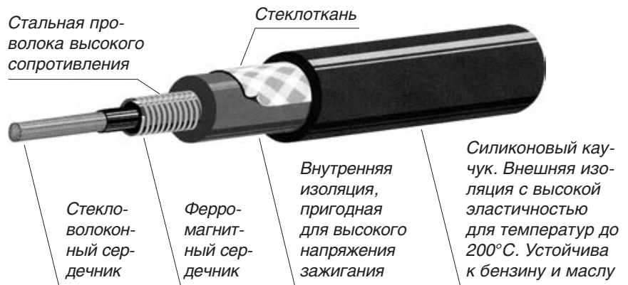
Рис. 3. Провода зажигания с реактивным сопротивлением. На стекловолоконный сердечник намотана проволока. Помехоподавляющий резистор рассчитывается исходя из формулы: 1 м кабеля = 2,2 кОм при работе на высоком напряжении. Эта система используется в автомобилях Citroen, Peugeot, Renault, Nissan, Toyota, Volvo и др.
