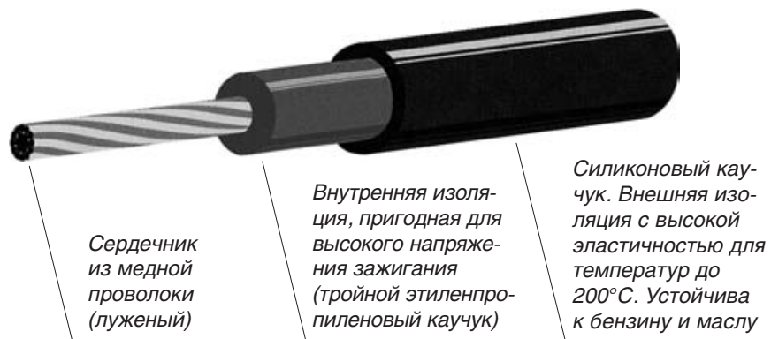
Рис. 1. Медные провода с помехоподавляющими наконечниками. Диаметр медного сердечника – 7 мм. Помехоподавляющий резистор закреплен в штекерных разъемах свечи и распределителя. Таким образом, защита от радиопомех располагается вблизи источника помех. Эта система преимущественно используется в автомобилях Audi, BMW, Mercedes и VW.
