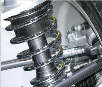
**П**ружина - упругий элемент подвески, удерживающая кузов на нужной высоте. На современных автомобилях используются винтовые пружины. Пружинные подвески были изобретены в 30-х годах XX века, но широкое применение получили только в 1950-х.
