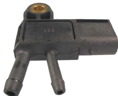
после сажевого фильтра и, таким образом, определяет разность давлений. Разность давлений увеличивается по мере загрязнения сажевого фильтра, что позволяет определить, когда сажевый фильтр необходимо регенерировать или заменить.
