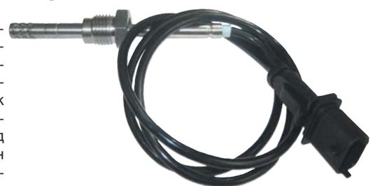
Датчик температуры выхлопных газов в основном имеет задачу защиты компонентов двигателя от перегрева. В дизельных двигателях датчик дополнительно имеет задачу контроля регенерации сажевого фильтра. Температура определяется с помощью резистора, сопротивление которого зависит от температуры, и передаваемого в систему управления двигателем. Соответственно, регулируется мощность двигателя, например, путем регулирования давления наддува.
