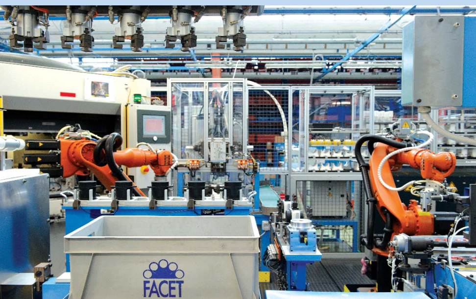
Ручных операций на сборке катушек зажигания не предусмотрено. На каждую катушку уходит порядка 7 километров проволоки!
