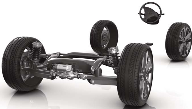
AKC (Active Kinematik Control) - задняя подвеска с подруливанием для Audi Q7 с центральным расположением актуатора. Задние колеса поворачиваются на угол до 3 градусов.
