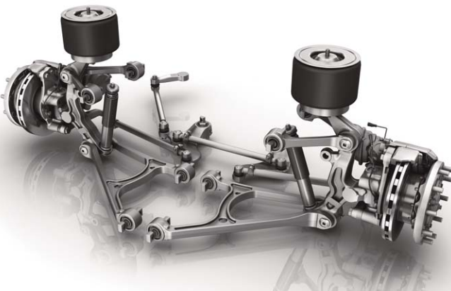
Благодаря новым конструкторским решениям и использованию альтернативных материалов новая подвеска для автобусов от ZF - RL 82 EC - позволяет увеличить максимальную осевую нагрузку до 700 кг.
