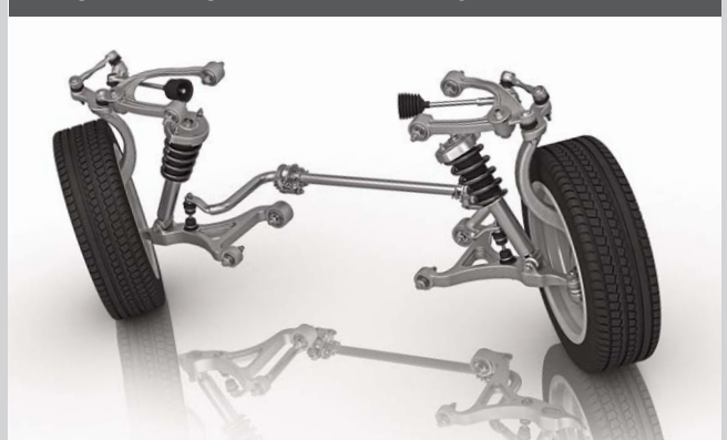
Устройство передней подвески Easy Turn
