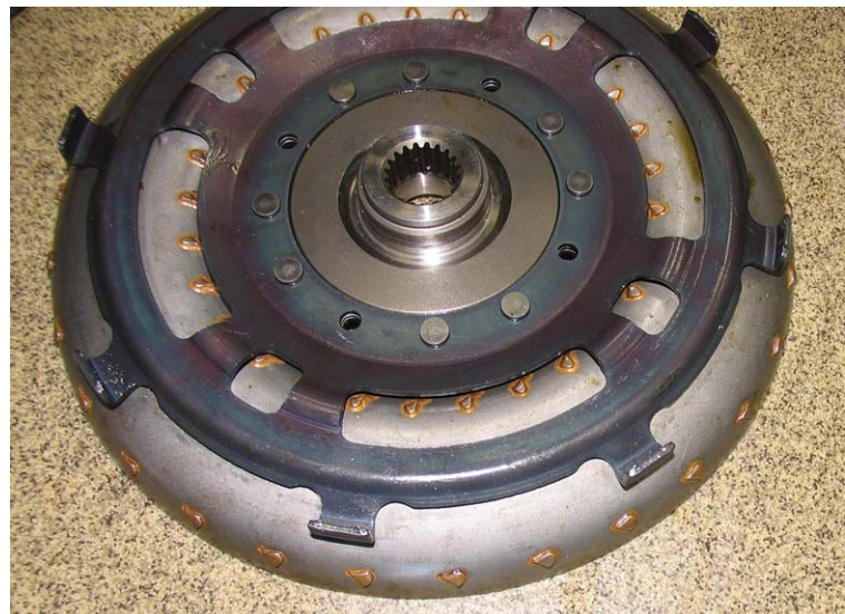
На турбинном и насосном колёсах гидротрансформатора в KIA (фото вверху) пропаяли все загнутые соединения для снижения потерь от перетекания трансмиссионной жидкости наружу полости при работе, что повысило КПД всей системы (в отличие от аналогов - фото внизу).
