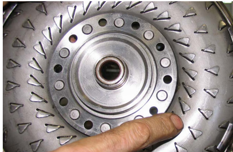
На турбинном и насосном колёсах гидротрансформатора в KIA (фото вверху) пропаяли все загнутые соединения для снижения потерь от перетекания трансмиссионной жидкости наружу полости при работе, что повысило КПД всей системы (в отличие от аналогов - фото внизу).
