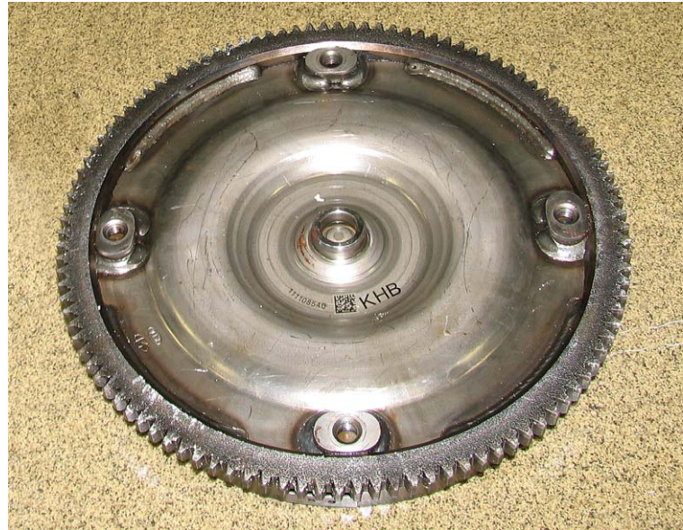
Зубчатый венец находится прямо на трансформаторе, вместо распространенного расположения на маховике, и приварен к корпусу гидротрансформатора - эта схема надежнее.
