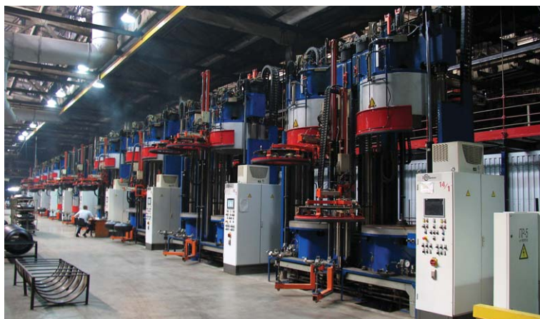
Нові форматори-вулканізатори КНР 52-180 IC (52") компанії Harburg Freudenberg, Німеччина, встановлені у 2017 р. Розраховані на вулканізацію шин до 22 дюймів.
