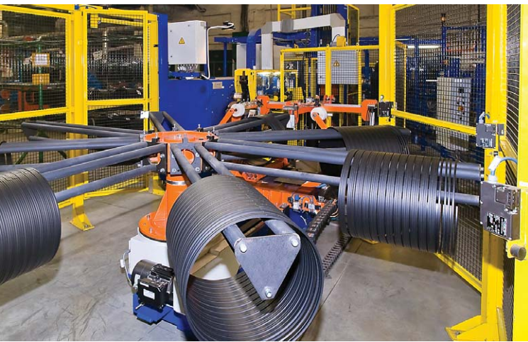
Кільцеровна лінія для виробництва бортових кілець Liberal компанії Viro, Словаччина.
