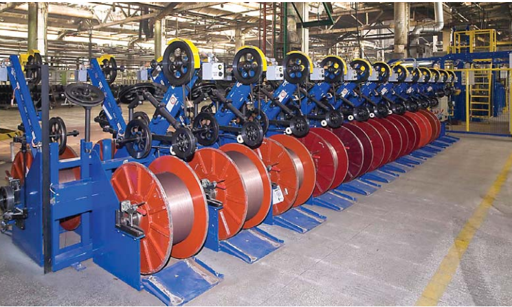
Кільцеровна лінія для виробництва бортових кілець Liberal компанії Viro, Словаччина.
