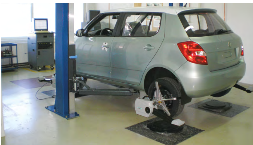
Для проверки правильности установки развала-схождения лаборатория, как и производство, использует стенд Beissbarth. Но здесь не требуется регулировка, поэтому достаточно двухстоечного подъемника и выставленных по уровню гранитных плит под колесами.
