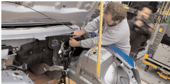
Установка шумоизоляционной защиты на автосборочном конвейере Cadillac.
