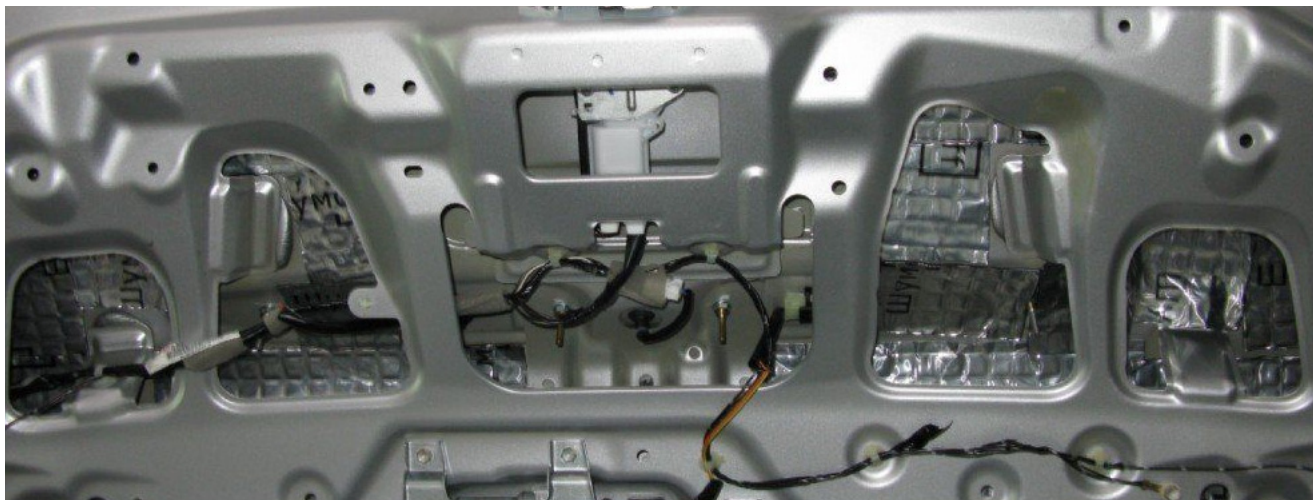
На филенке пятой двери в Suzuki SX4 локально устанавливается Шумофф М2
