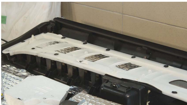
Вибропоглотитель на обшивку можно клеить на 100% поверхности, но технически это практически невозможно. Достаточно - 50%, оптимально - 70-80%.
