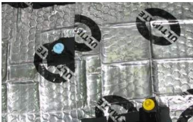
На пластиковой накладке пятой двери Kia Rio используется вибропоглотитель Ultimate Construct A1
