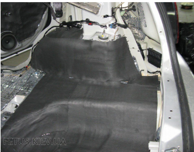
Термо- шумоизоляция Ultimate Soft на днище Suzuki SX4 - используется там, где это не затрудняет сборку
