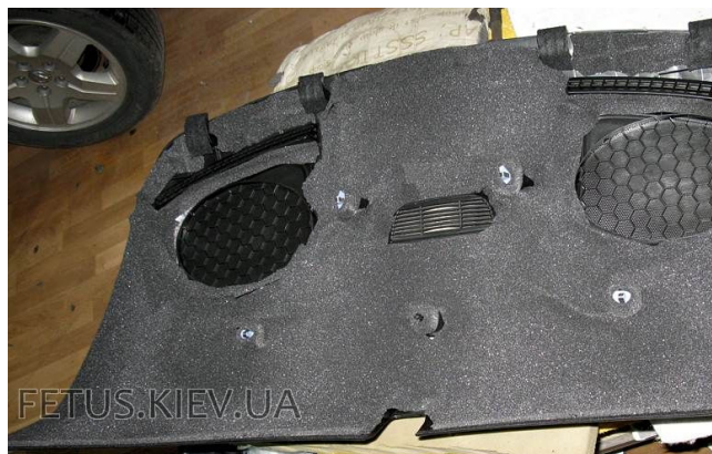
Части накладки задней полки Chevrolet Camaro выклеиваются по всей площади шумопоглотителем Шумофф Герметон о шумоизоляции крыши и дверей. Материалы: Шумофф П4, П8, Шумофф Комфорт, Ultimate Polifoam и Ultimate Soft.
