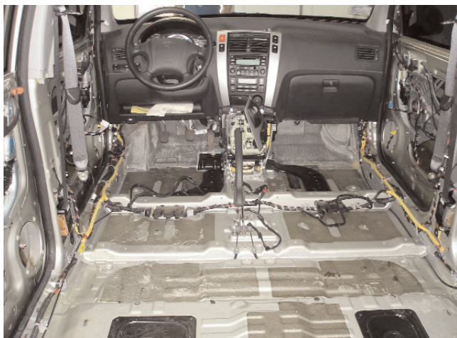
Перед тем, как приступить к установке шумоизоляции, салон автомобиля разбирается. Почти полностью...
