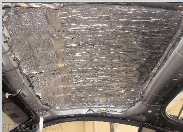
Фото 3. Металлизированный Ultimate Soft-10 прекрасный термо- и шумоизолятор.
