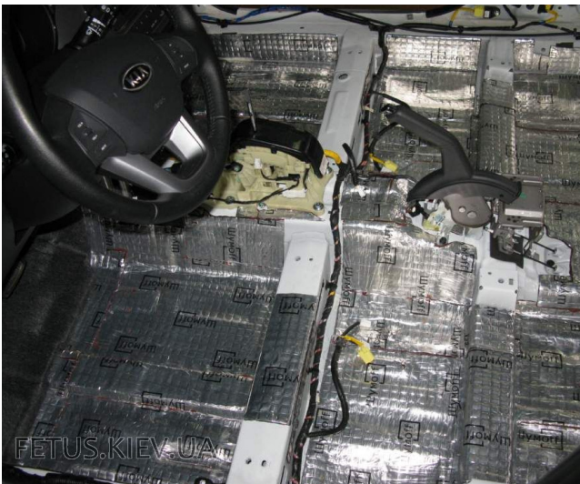
Для локальной работы по вибропоглощению на ребрах и порогах можно использовать Шумoff М3, пример - Kia Rio
