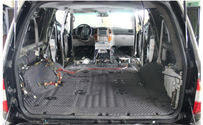
Шумопоглотитель Шумофф Герметон 15 устанавливается для наилучшего результата шумоизоляции
