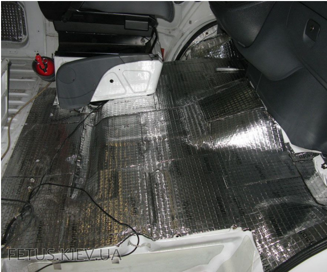
Обработка моторного отсека и днища Mercedes Sprinter комбинированным материалом Шумoff Микс Ф
