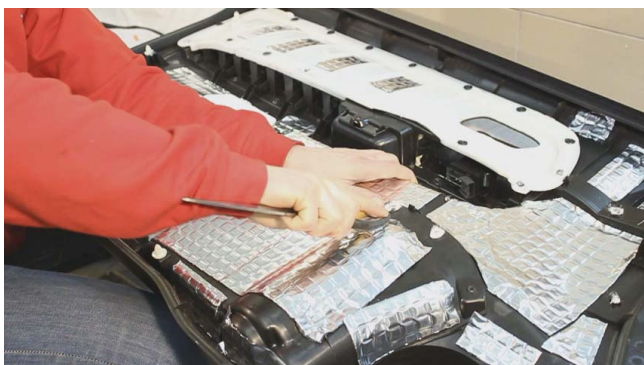
Вибропоглотитель на обшивку можно клеить на 100% поверхности, но технически это практически невозможно. Достаточно - 50%, оптимально - 70-80%.
