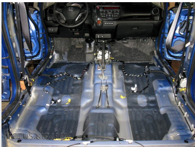
Салон Honda Jazz готов к работам по установке шумоизоляции. Как видно на фото, производителем уже установлен вибропоглотитель
