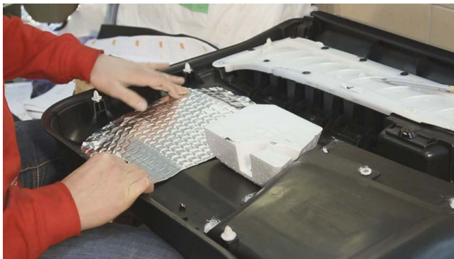
Вибропоглотитель на пластик можно клеить не только полосками ("зеброй"), но и произвольными сегментами. На карте двери лучше клеить более легкий материал Шумофф L2.
