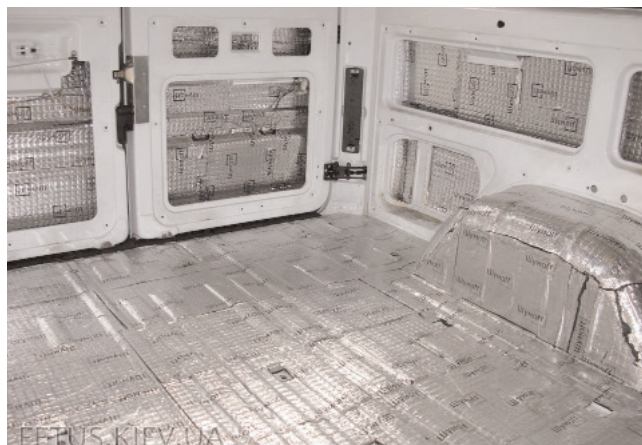
Полная шумоизоляция грузового микроавтобуса Mercedes Sprinter перед переоборудованием в кемпер. Использовались материалы максимальной эффективности.
