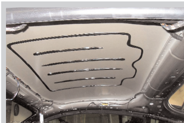
Фото 1. Удаление штатной войлочной шумоизоляции с крыши автомобиля.
