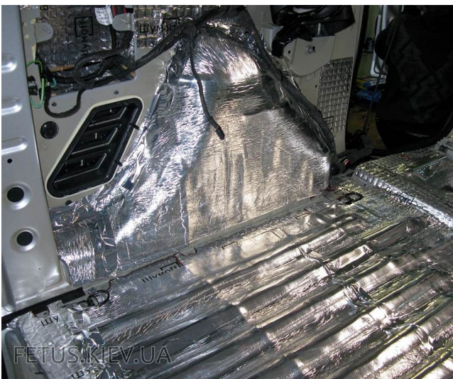
Ultimate Soft металлизированный в качестве барьерного слоя на полу багажника и задних арках Peugeot Partner Терее
