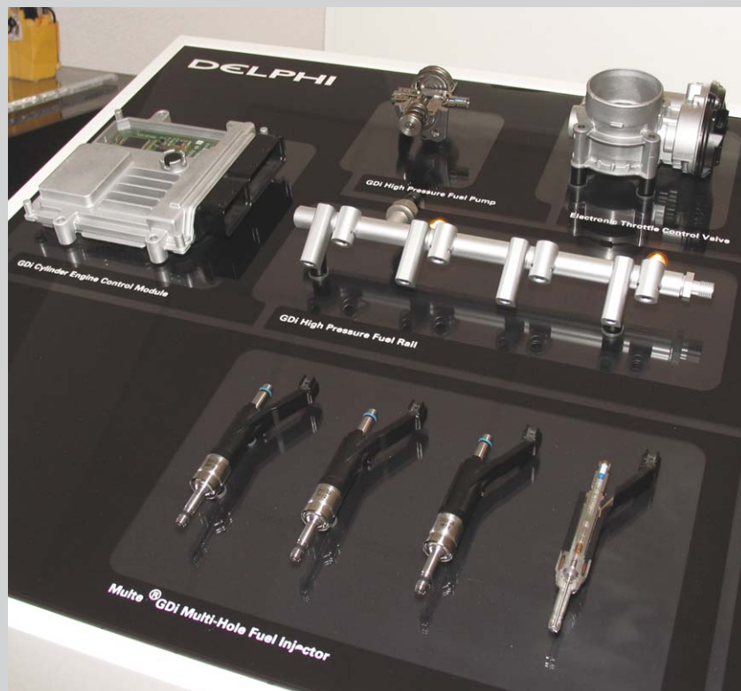
Фото сверху, слева направо по кругу: модуль управления двигателем с прямым впрыском GDi, топливный насос высокого давления для двигателей GDi, электрическая дроссельная заслонка, топливная рампa высокого давления, инжекторы Multec GDi.
