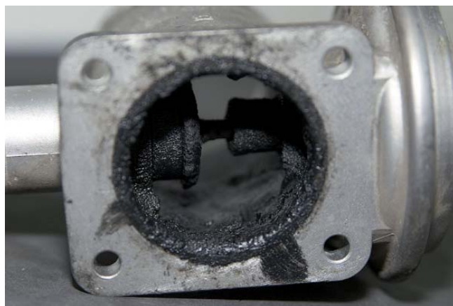
Грязь на клапане системы EGR.
