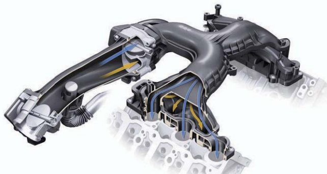
Схема движения воздуха во впускном коллекторе - атмосферный воздух смешивается с горячими газами, поступающими через рециркуляционный клапан EGR.
