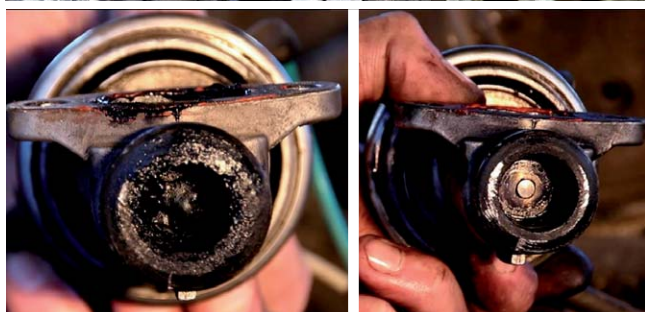
Результат работы Xenum I-Flux 100 налицо. Отложения сажи во впускном коллекторе до и после очистки.
