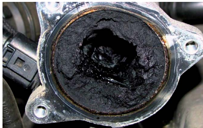
Нагар в мазутоподобном состоянии не оставляет ни одного шанса для возможности работы дизельного мотора.
