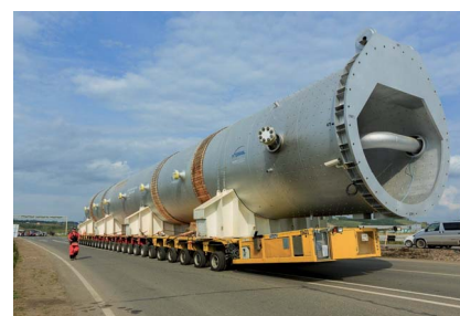
Транспортировка на Ачинский НПЗ (Россия) реактора гидрокрекинга. Вес установки - 1 300 тонн, плюс автопоезд, который предназначен для его перевозки, - ещё полторы тысячи тонн. Это, в общей сложности, вес хорошей пятиэтажки.
