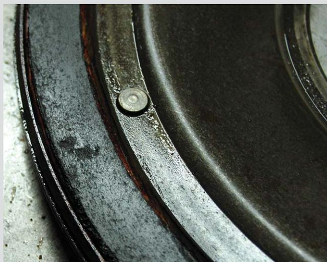
Последствия некачественного фрикциона для поршня блокировки гидротрансформатора: частицы накладки попали в гидравлический блок и заклинили клапаны. В компании применяют качественные фрикционы, преимущественно американские.
