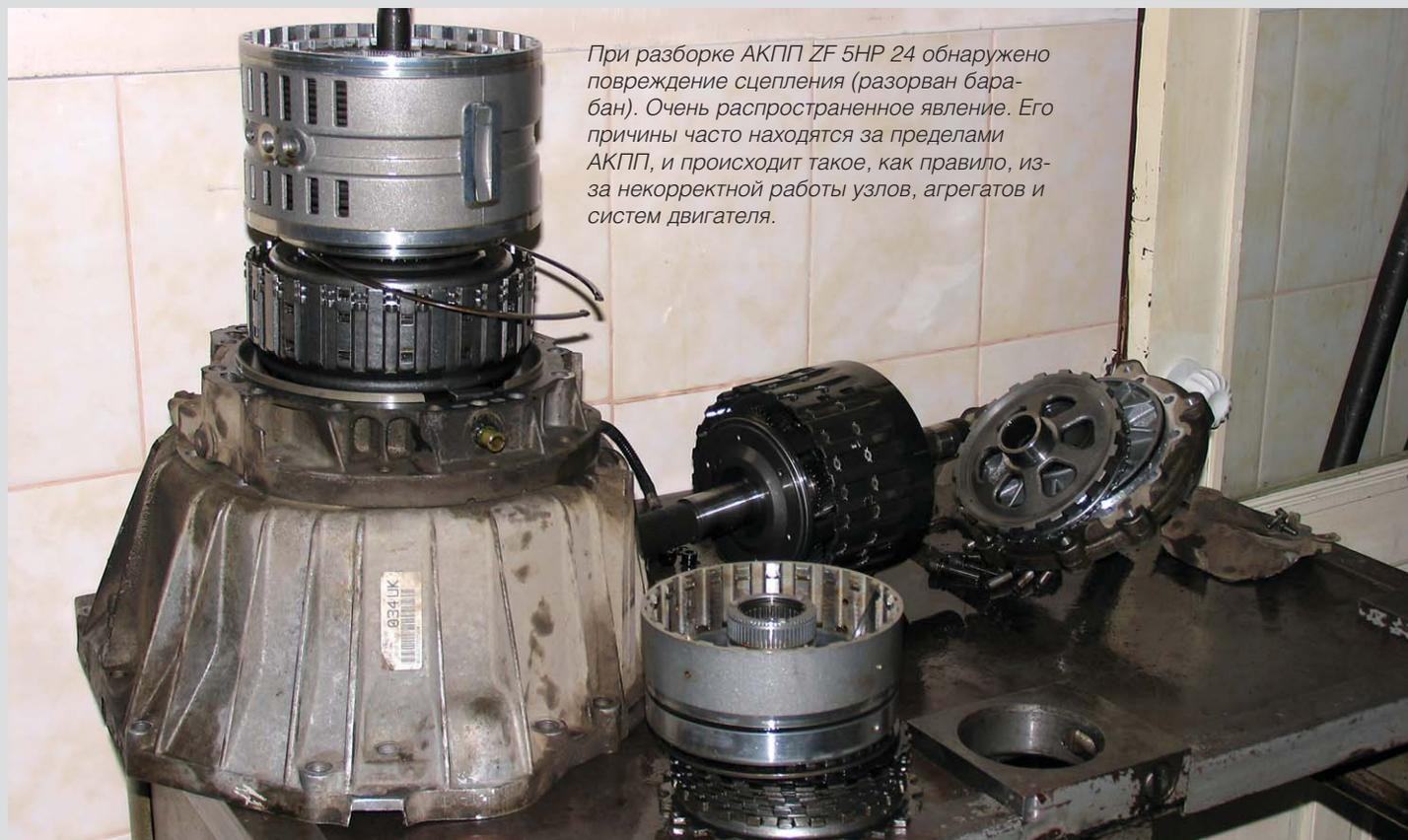
При разборке АКПП ZF 5HP 24 обнаружено повреждение сцепления (разорван барабан). Очень распространенное явление. Его причины часто находятся за пределами АКПП, и происходит такое, как правило, из-за некорректной работы узлов, агрегатов и систем двигателя.
