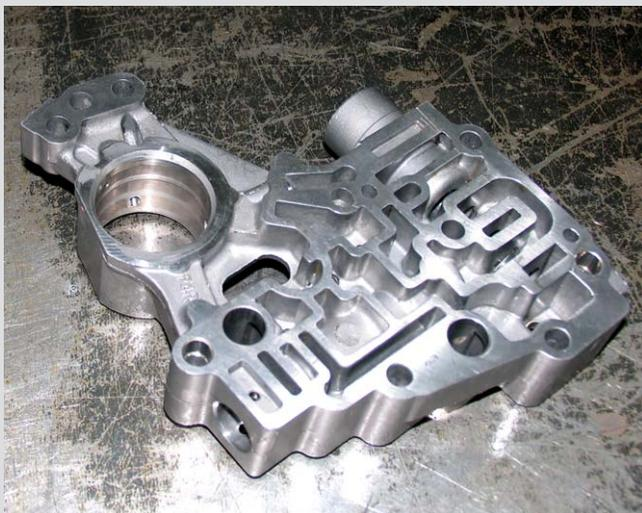
На «West Transmission» научились восстанавливать корпусную деталь гидравлического блока АКПП автомобиля Honda. ... а также разрушенные гидроцилиндры «А» с входным валом сцепления АКПП ZF 5HP 24.
