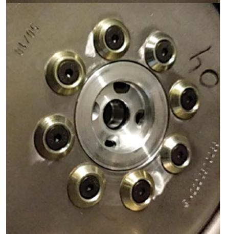
Закаленные болты и конические шайбы в сочетании со специальным клеем во время монтажа муфты гидротрансформатора выполняют свою роль не хуже заводских заклепок, считает Рони Зелеченок.
