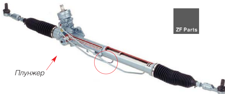
Отрегулировать люфт можно с помощью плунжера.
