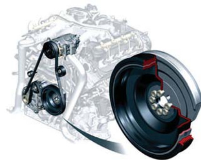
Место установки демфера крутильных колебаний - носок коленвала. Он совмещает также и функцию шкива ременного привода.
