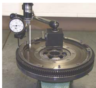
Проверка угла кручения ДММ.
