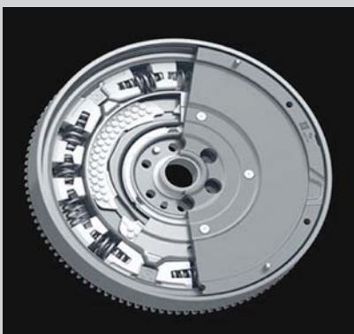
Двухмассовый маховик для небольших и средних двигателей до 350 Нм. Встроенная поверхность трения пропорционально увеличивает сопротивление при увеличении угла поворота вторичной массы относительно первичной массы.
