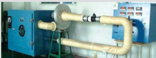
Испытание ДМРВ при высокой температуре в 120°C (фото сверху) и при температурах -15°C и ниже (фото внизу).
