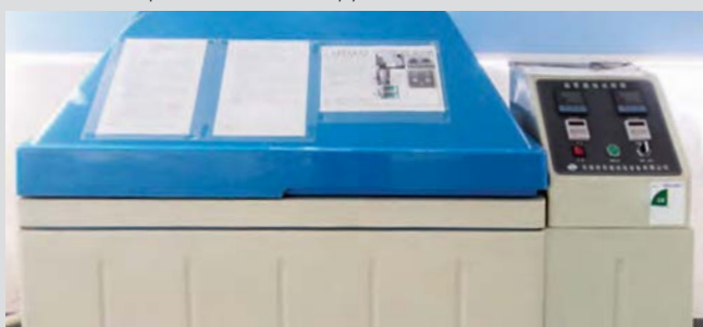
Резкие перепады температур от - 40°C до +120°C: 10 минут при низких температурах, 2 минуты при изменяющихся, 10 минут при высоких температурах (25 повторений).
