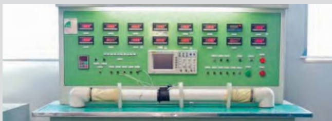
Испытание при температуре 35 +/- 2 °C в 5% растворе соленой воды на восприимчивость к коррозии, длительность - 96 часов.
