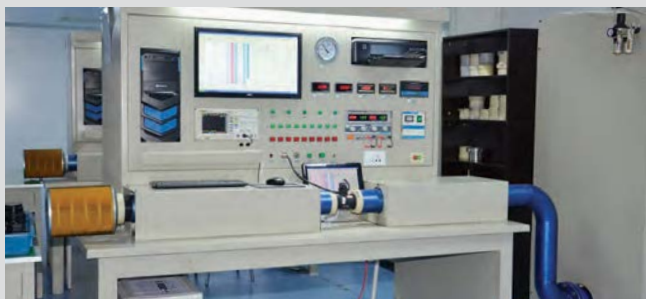
Установка для калибровки ДМРВ. Абсолютно все датчики калибруются для обеспечения максимальной точности показаний.
