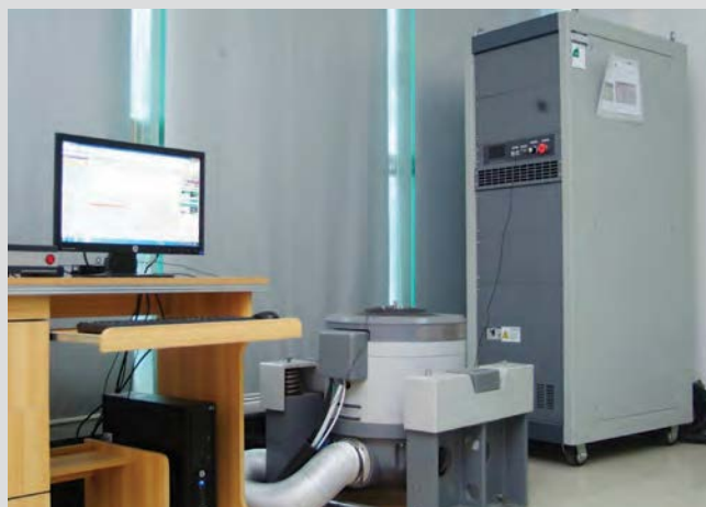
Испытание на устойчивость к вибрациям. Это очень важные испытания, поскольку нередко слишком жесткие вибрации, особенно в дизельных двигателях, приводят к поломке микросхемы датчика.
