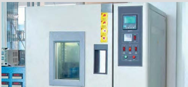
Установка для калибровки ДМРВ. Абсолютно все датчики калибруются для обеспечения максимальной точности показаний.
