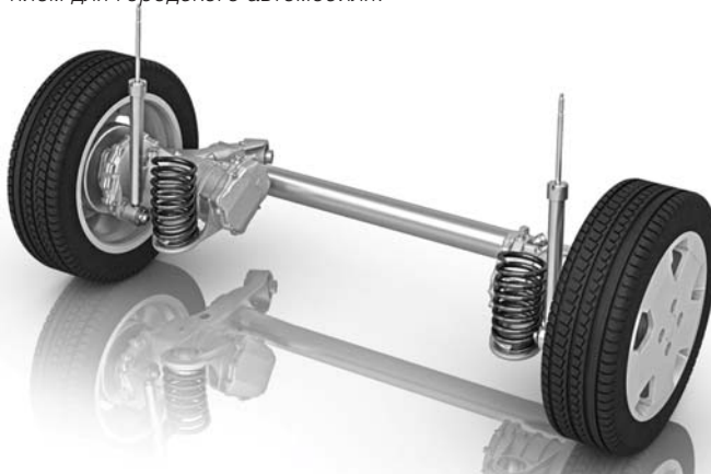
Electric Twist Beam (eTB) - инновационная концепция моста с приводом от двух электродвигателей с выходной мощностью 40 кВт каждый. Электродвигатели интегрированы в полунезависимую заднюю подвеску вплотную к колесам. Эта концепция привода дает преимущества особенно для «малолитражек» и микроавтомобилей. С крутящим моментом 1400 Нм и максимум 21000 оборотов в минуту транспортное средство достигает максимальной скорости 150 км/ч.
