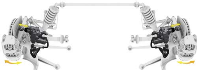
ZF AKC Porsche Dual Version - система используется в моделях Porsche 911 Turbo с двумя актуаторами (по одному для каждой стороны задней независимой подвески).
