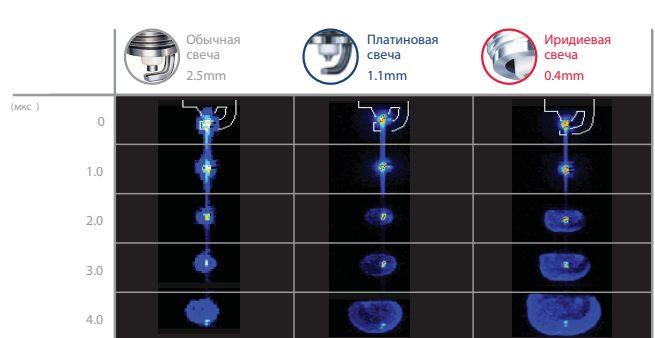
Анализ процесса зажигания с помощью фотосъемки.
