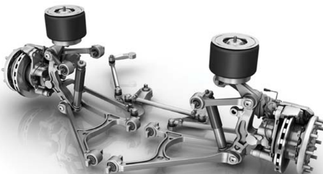
ZF AVE 130 - полностью электрический порталный мост для низкопольных городских автобусов.
