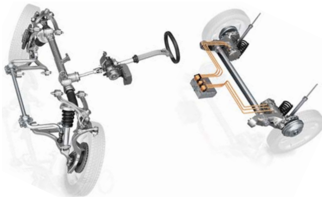
Новая подвеска для городских электрокаров от ZF «Intelligent Rolling Chassis» (IRC - «шасси интеллектуального вождения»). Она имеет радиус поворота до 75 градусов по сравнению со стандартными 50 градусами, что делает ее идеальным решением для городского автомобиля.
