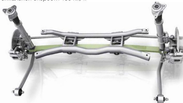
Задняя подвеска ZF Lightweight Axle CLA с поперечной рессорой из стекловолокна для легковых автомобилей весит на 13% меньше, чем многорычажная.
