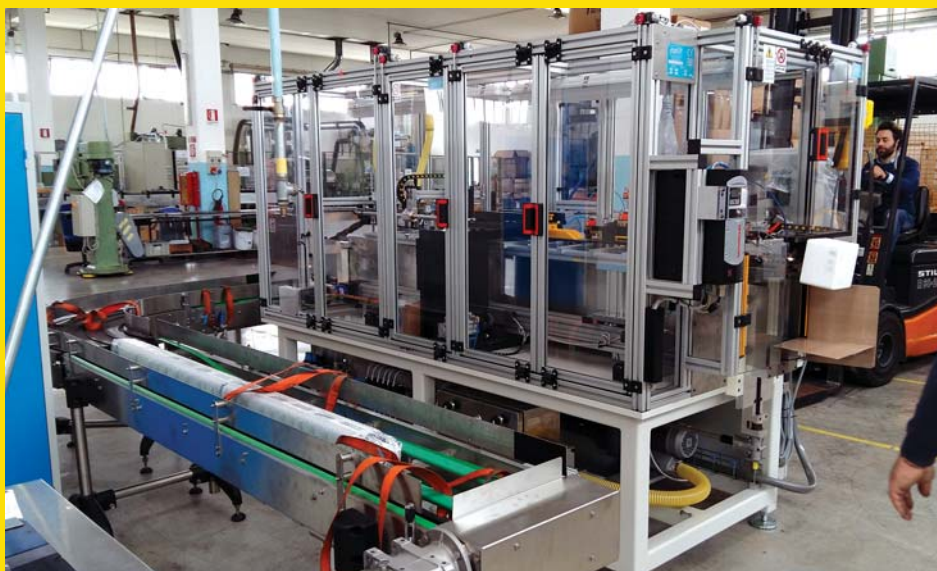
Технология инфракрасной сварки для соединения гофрошторы с торцевым элементом картриджа уже несколько лет применяется на заводе TECNECO.
