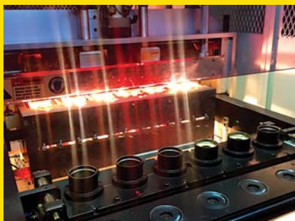
Технология инфракрасной сварки для соединения гофрошторы с торцевым элементом картриджа уже несколько лет применяется на заводе TECNECO.
