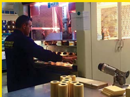
Технология инфракрасной сварки для соединения гофрошторы с торцевым элементом картриджа уже несколько лет применяется на заводе TECNECO.
