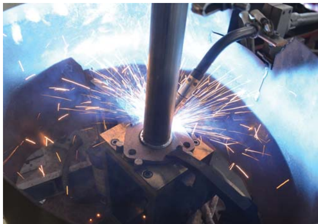
Сварка выполняется автоматами, обеспечивающими ровный шов.
