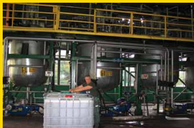
В промышленных миксерах, смешивающих базовые масла и присадки, поддерживается определенная температура и интенсивность перемешивания. Информация о температуре и объеме смешиваемого в миксере масла отображается на специальных датчиках.
