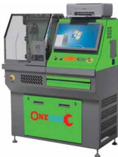
DiMed EXAM – стенд для тестирования насосов легковых автомобилей и микроавтобусов.
