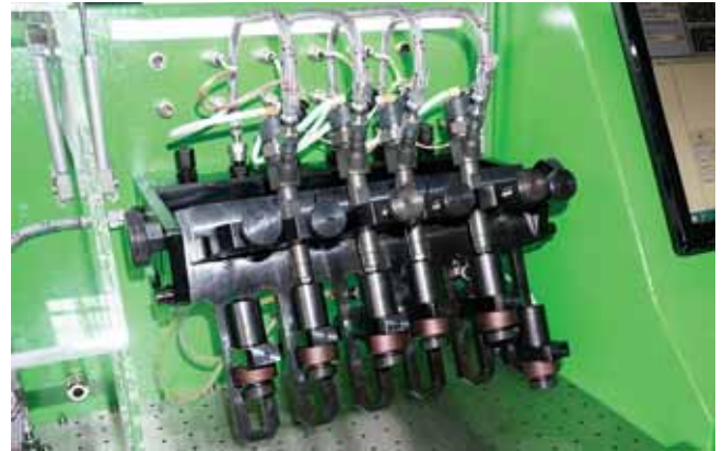
Универсальное 6-канальное крепление для инжекторов.
