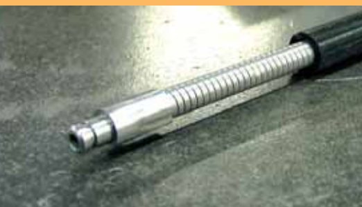
Витье сердцевинной из стальной проволоки
