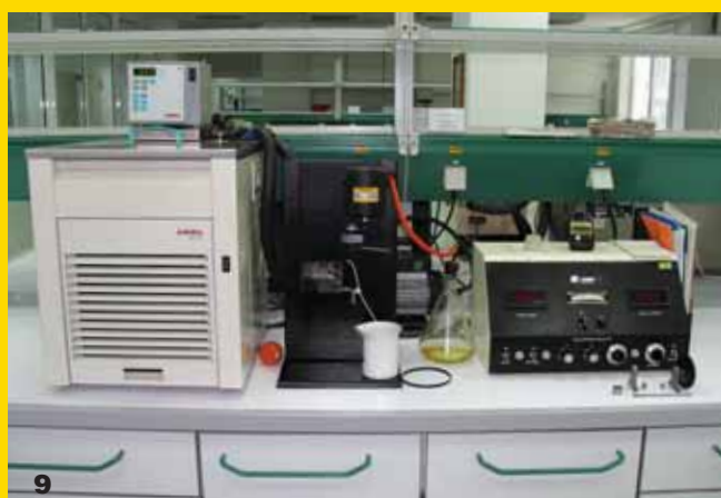
9. Аппарат CCS – симулятор «холодного запуска». Стенд для проверки вязкости моторного масла при температурах -5^{\circ}\text{C} , -35^{\circ}\text{C} .
