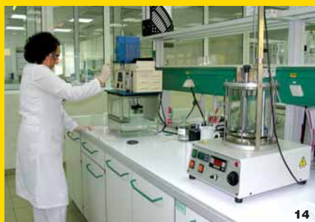
10. Определение кинематической вязкости масел при определенных температурах.
