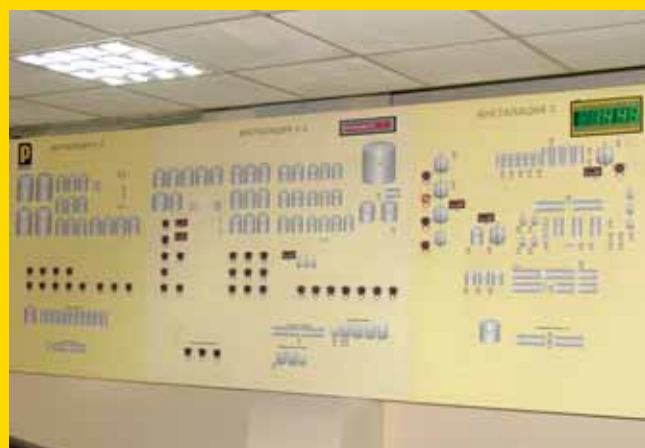
Управление всеми автоматизированными процессами на заводе осуществляется с одного пульта при помощи специально разработанного для «Приста Ойл» программного обеспечения. Информация о процессах отображается на индикаторном табло.
