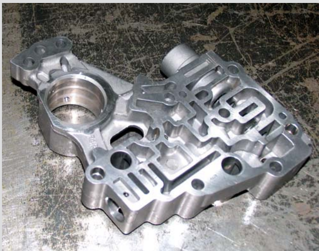
На «West Transmission» научились восстанавливать корпусную деталь гидравлического блока АКПП автомобиля Honda.
