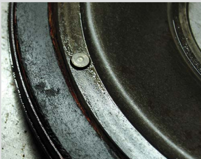
Последствия некачественного фрикциона для поршня блокировки гидротрансформатора. Частицы фрикционной накладки попали в гидравлический блок и заклинили клапаны. В «West Transmission» применяют качественные фрикционы, преимущественно американские.
