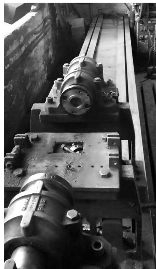
Балансировка карданных валов обязательна при их ремонте. На фото – первый профессиональный стенд для балансировки карданных передач, установленный в Украине.
