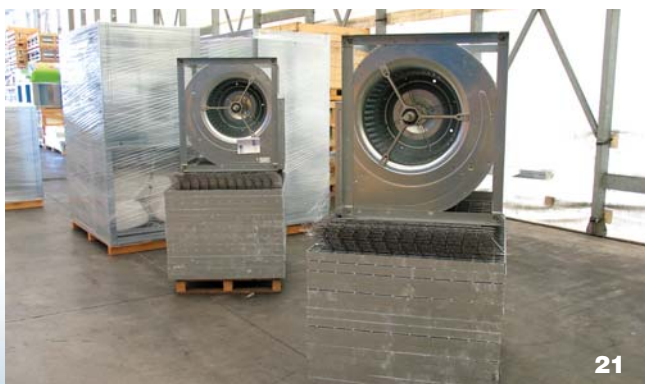
Графическое отображение превосходства промышленных турбин прямого сочленения с двигателем перед трансмиссионными системами вентиляции.
