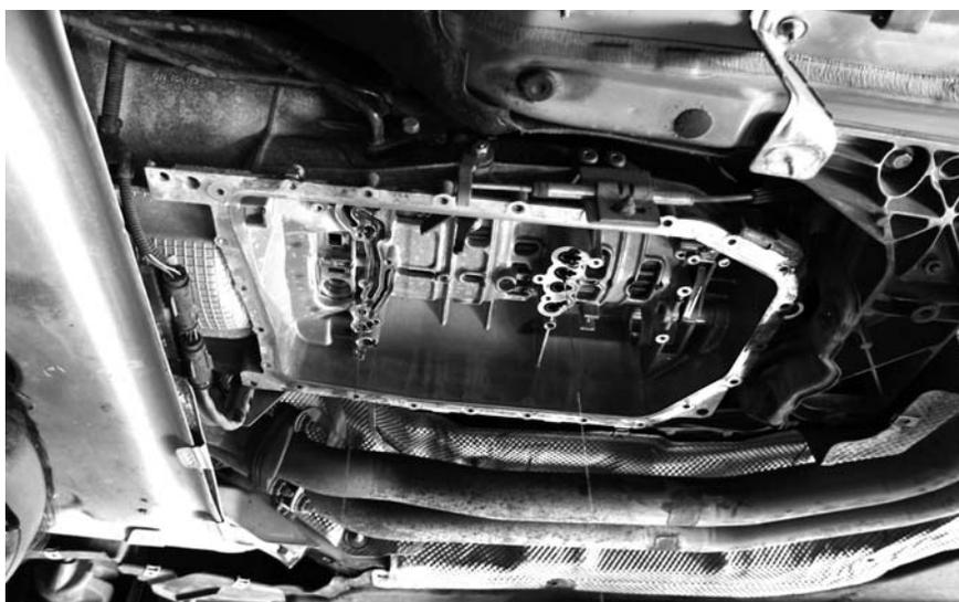
Снятие мехатроники открывает доступ к отверстиям, через которые ATF попадает из АКПП в устройство и обратно.
