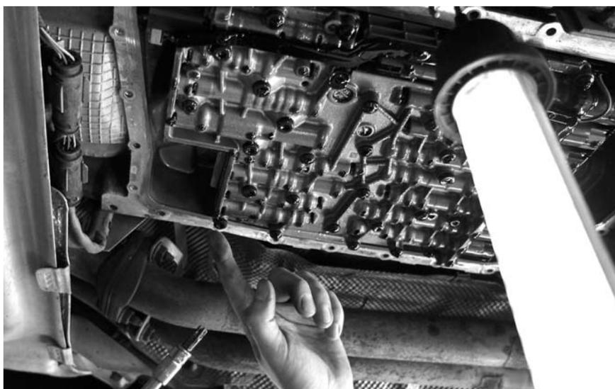
Откручивать нужно болты с крупными головками (M40), они крепят мехатронику к АКПП. Более мелкие болты (M27) скрепляют между собой части устройства.
