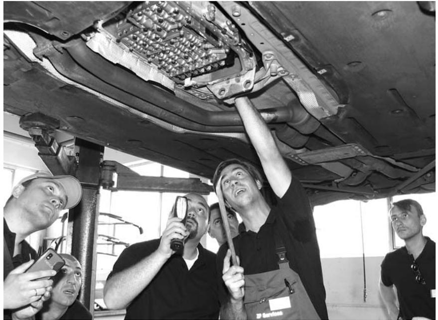
*Извлечь руками защитную втулку мехатроника затруднительно, поэтому мастер прибегает к помощи монтировки. Эта операция абсолютно безопасна, если инструмент находится в умелых руках.*
