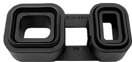
После длительного использования уплотнительная резинка на "очках" заменяется. По этой причине повторное использование детали может нарушить герметичность соединения отверстий для циркуляции ATF между мехатроником и АКПП. Деталь подлежит замене.
