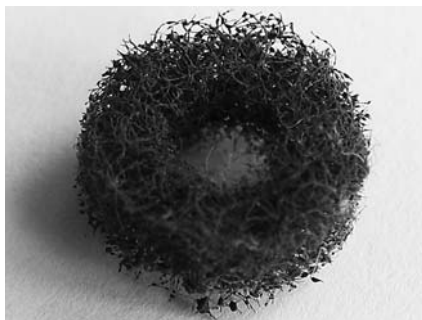
Для очистки кольцевых клемм можно воспользоваться специнструментом с насадкой из абразивного материала.
