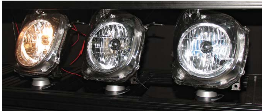
Подвергаемая проверке лампа вставляется в одну из фар на стапеле.
