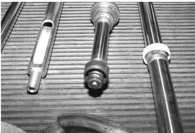
Разобранный амортизатор и удерживающая возвратную пружину гайка.
