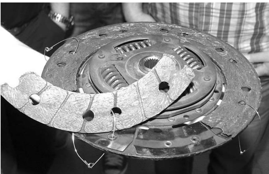
Разрыв фрикционной накладки из-за чрезмерной раскрутки диска сцепления.
