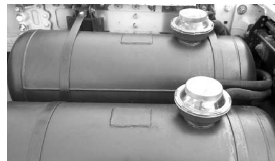
Установка двух газовых баллонов вместительностью 100 л каждый обусловлена габаритами и свободным местом на автомобиле.
