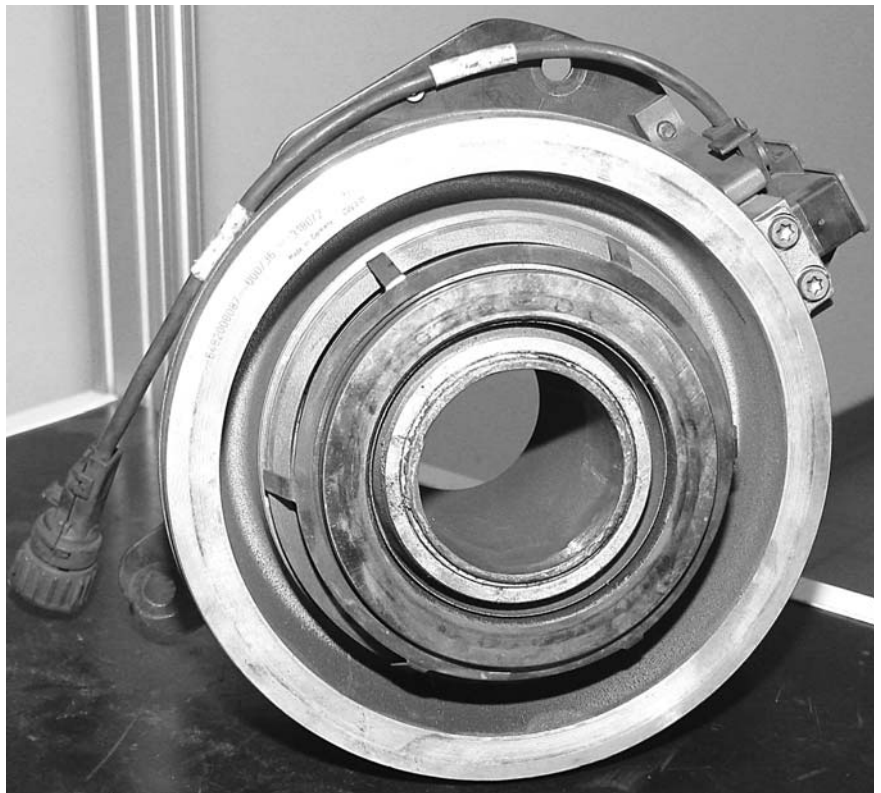
Повреждения электропневматического выжимного подшипника, вызванные неправильной установкой диска сцепления.
