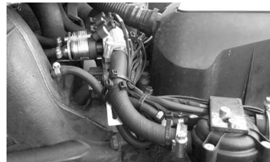
Впрыск газа во впускной коллектор через форсунки HANA.
