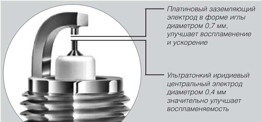
Iridium Tough Super Ignition (SIP) – первая в мире иридиевая свеча 0,4 мм с двумя игольчатыми электродами.
