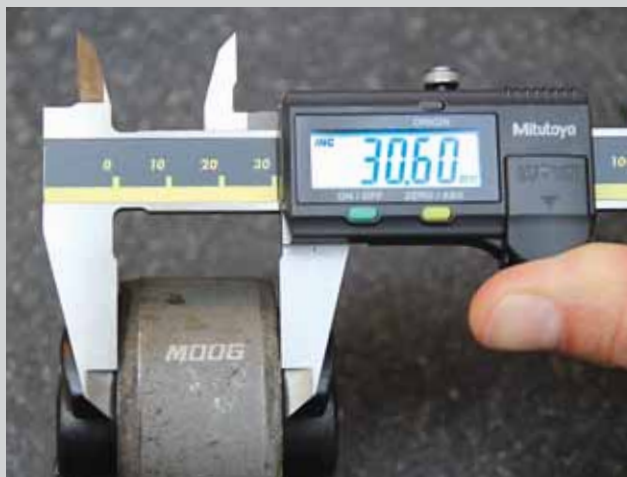
Цифровой штангенциркуль позволяет измерить ширину гильзы сайлентблока с точностью до второго знака после запятой.
