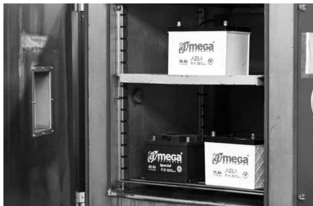
Процесс тестирования готовой продукции в заводской лаборатории: тест на цикличность и морозильная камера.
