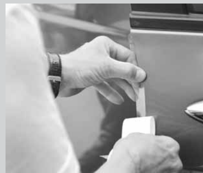
Лента 3M защищает край двери от сколов, возможных при касании другого автомобиля на парковке.
