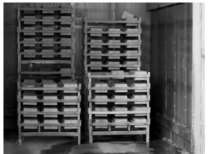
Процесс созревания пластин происходит в специальных камерах Catelli (Италия).
