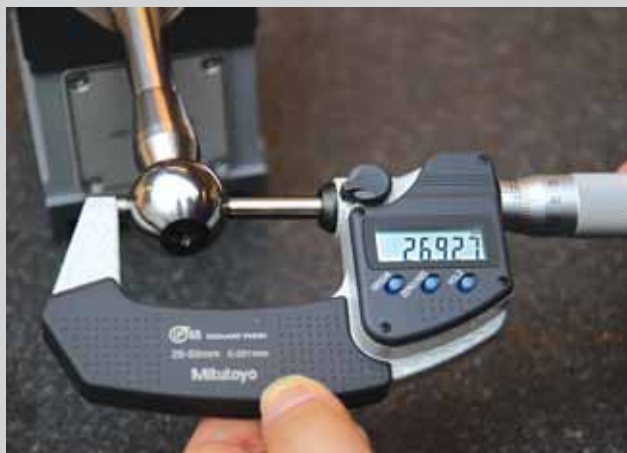
Высокоточный микрометр позволяет измерить диаметр шара (например, цапфы шарового шарнира) с точностью до тысячных долей миллиметра (микрон).
