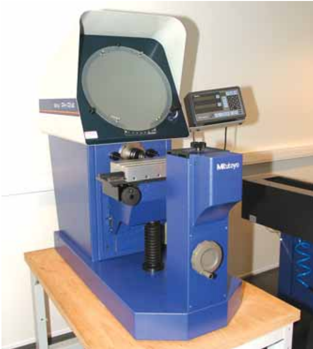
Профиль-проектор, используемый для копирования геометрических параметров мелких деталей.
