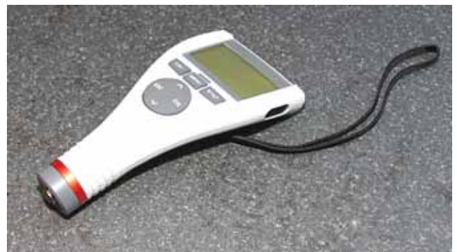
Толщина покрытия металлических деталей измеряется с помощью электромагнитного толщиномера с точностью до десятых долей микрометра (т.е. до 0,0001 мм).
