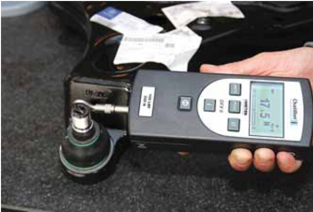
Динамометрические инструменты применяются для определения усилия, необходимого для смещения пальца шарнира или для проворачивания цапфы в шарнире вокруг оси пальца (с точностью до сотых долей Ньютон/метра).
