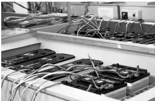
Процесс тестирования готовой продукции в заводской лаборатории: тест на цикличность и морозильная камера.
