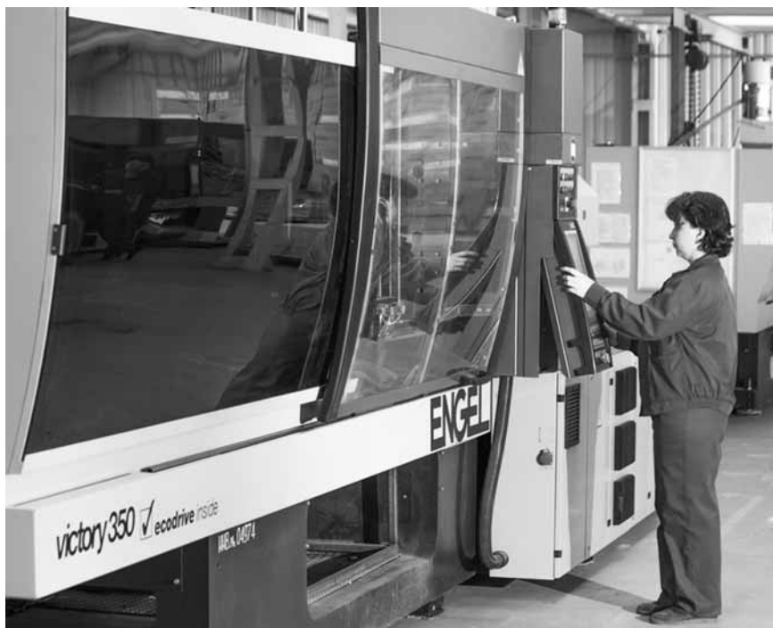
Пластиковые комплектующие – корпуса, крышки, наклейки и т.д. – производятся на австрийских термопласт-автоматах фирмы Engel.
