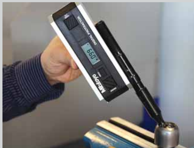
Гироскопический измеритель угла наклона применяется для измерения максимального угла отклонения пальца в шарнире.
