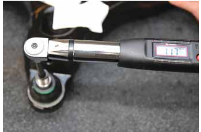
Динамометрические инструменты применяются для определения усилия, необходимого для смещения пальца шарнира или для проворачивания цапфы в шарнире вокруг оси пальца (с точностью до сотых долей Ньютон/метра).
