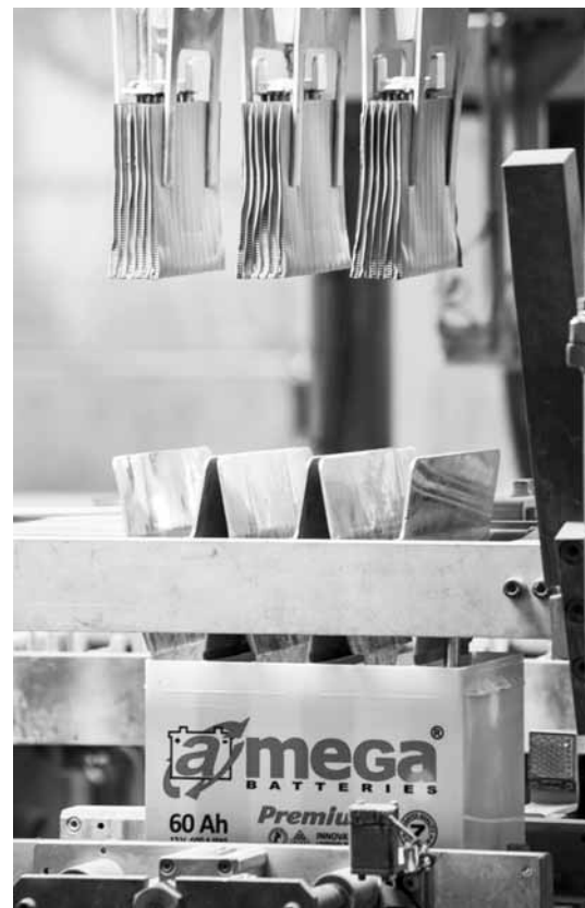
Процесс сборки АКБ осуществляется на роботизированной линии.
