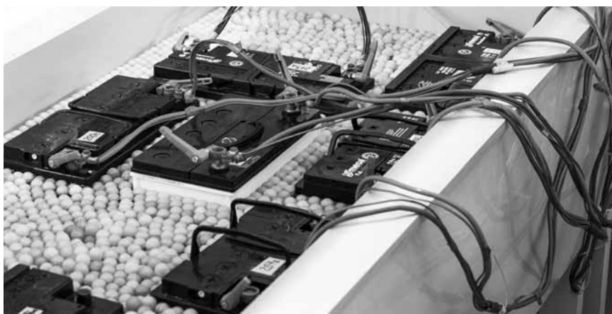
Также они проверяются холодом в «ванне», наполненной холодными шариками из материала с высокой теплоемкостью.
