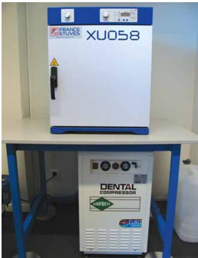
В барокамере резина нагревается до требуемых температур.
