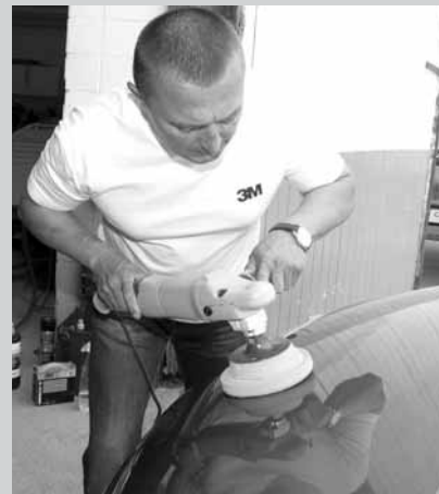
VAN позволяет отполировать деталь кузова даже «в поле» благодаря своей автономности.
