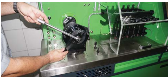
Фото 14. Благодаря вращающейся фланцевой стойке обеспечен легкий доступ к насосу.
