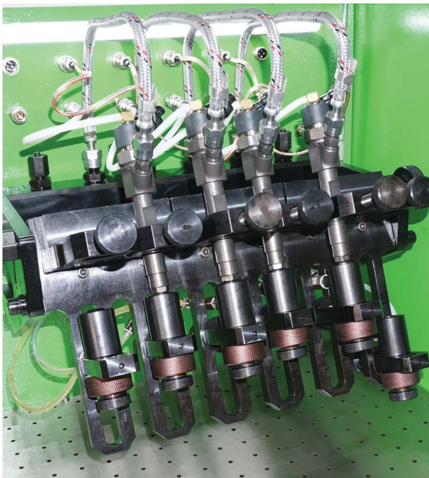
Фото 6. Универсальное шестиканальное крепление для инжекторов.
