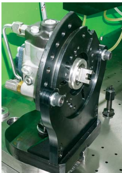
Фото 3. Отверстия на каждом из адаптерных фланцев совпадают с точками крепления большого количества типов насосов.
