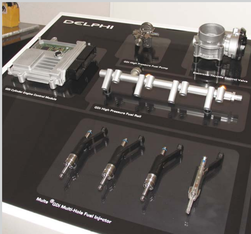
Фото сверху, слева направо по кругу: модуль управления двигателем с прямым впрыском GDi, топливный насос высокого давления для двигателей GDi, электрическая дроссельная заслонка, топливная рампа высокого давления, инжекторы Multec GDi.
