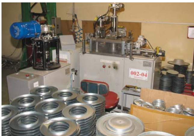
В собственном цеху металлообработки изготавливаются металлические каркасы для грузовых фильтров, перфорированные пластины для панельных, прочие элементы.
