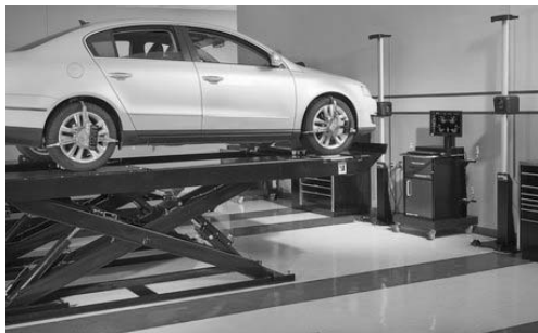
Компоновка стенда топ-серии Hofmann Geoliner 790 с расположением камер на двух независимо стоящих колоннах позволяет сделать его не только «проездным», но и мобильным (при комплектации колонн платформами на колесах). Цена: 17700 Euro
