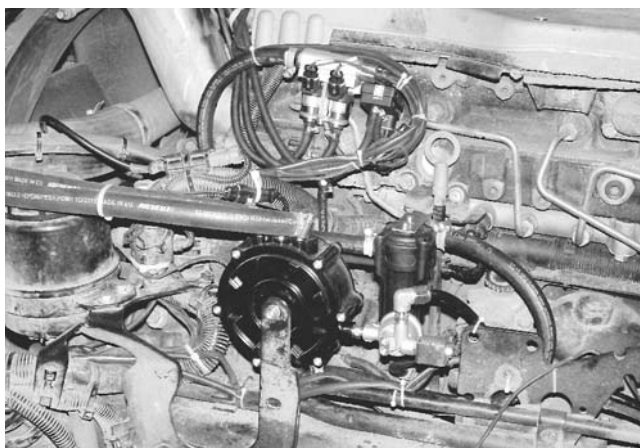
Фото на странице: Газовая аппаратура на MAN TGS.
