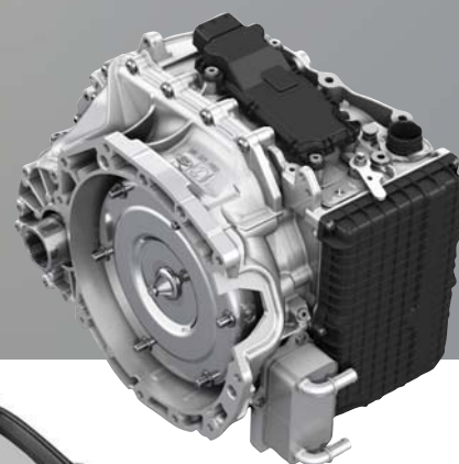
Не имеющая аналогов в автомобилестроении 9-ступенчатая автоматическая трансмиссия ZF устанавливается на Acura MDX и TLX.
