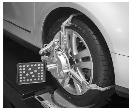
Выбор комплектации стенда Geoliner 790 с мишенями на захватах за диск либо за шину не влияет ни на точность измерений, ни на цену стенда.
