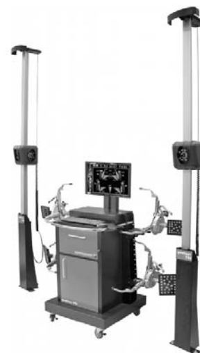
Компоновка стенда топ-серии Hofmann Geoliner 790 с расположением камер на двух независимо стоящих колоннах позволяет сделать его не только «проездным», но и мобильным (при комплектации колонн платформами на колесах). Цена: 17700 Euro
