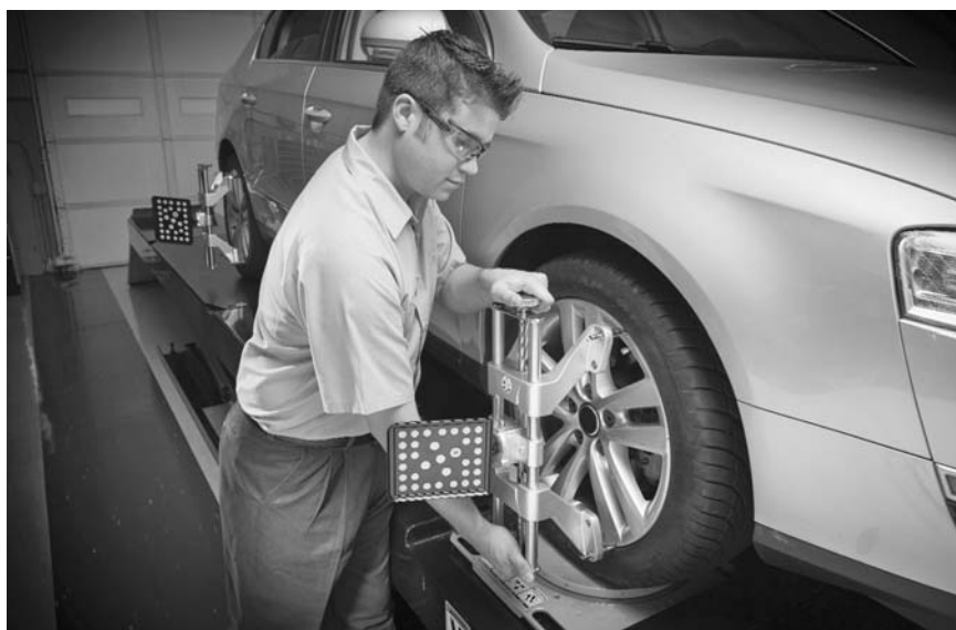
Колесные мишени стенда нового поколения вдвое меньше обычных, что не только облегчает работу с ними, но и позволяет проводить измерения с более близкого расстояния.
