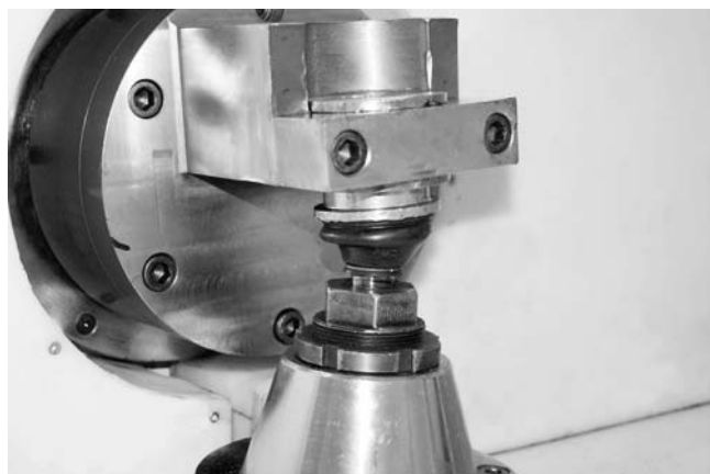
При испытаниях шаровых шарниров моделируется движение пальца по траекториям и с нагрузками, аналогичным возникающим в ходе реальной эксплуатации.
