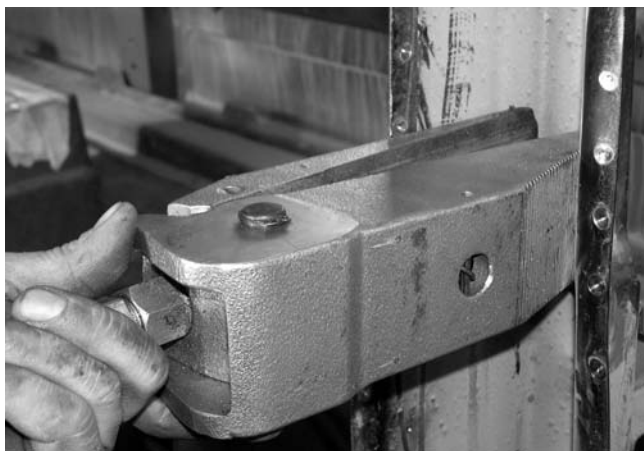
Клиновидным гидроцилиндром правится короб стойки.
