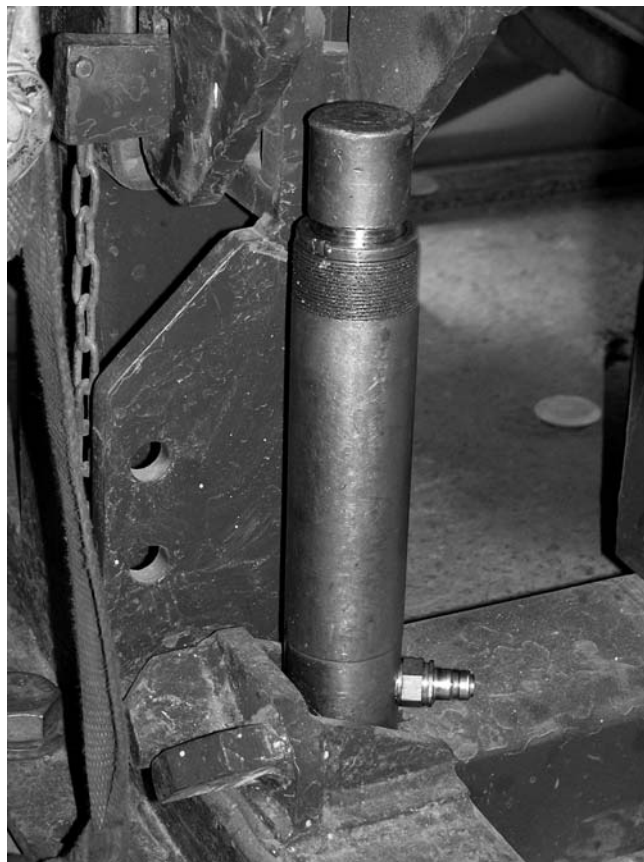
При правке геометрии кабины одна ее сторона удерживается цепью, а вторая – поддомкрачивается гидроцилиндром.
