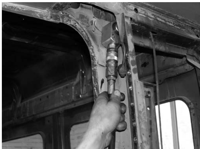
Такой миниатюрный гидроцилиндр значительно облегчает правку труднодоступных мест.
