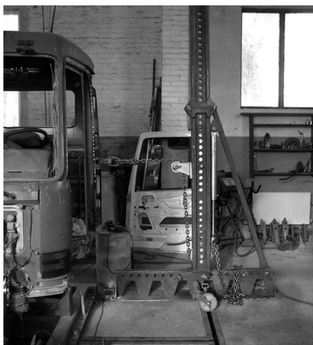
Вытягивающая башня создает точку опоры для удерживающей цепи.
