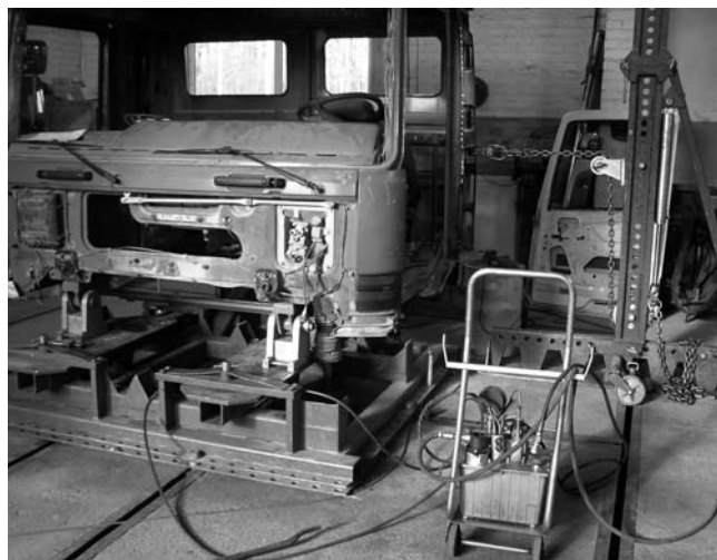
Этот гидронасос имеет 4 рукава, позволяющие задействовать одновременно 4 гидроцилиндра.
