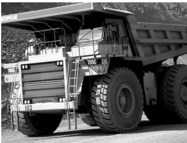
Фото 16. Caterpillar 785C перевозит 136 т железной руды сразу!
