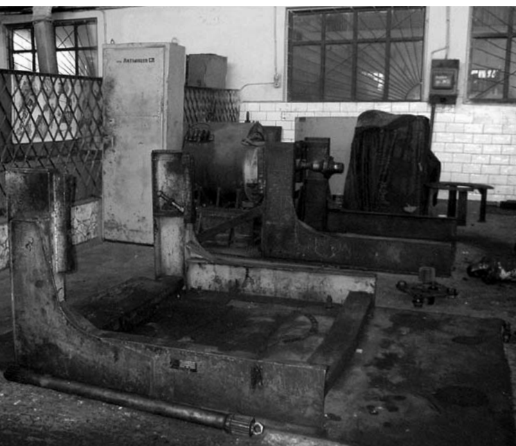
Фото 5. Здесь обкатываются мотор-колеса и бортовые редукторы.
