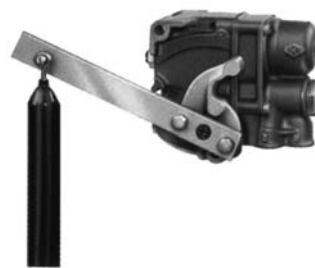
Автоматический, зависящий от загруженности регулятор тормозного усилия.
