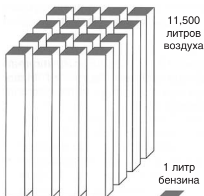
Рис. 3. Стехиометрическое соотношение компонентов топливно-воздушной смеси, необходимое для идеального сгорания с минимальным возможным уровнем выделения загрязняющих веществ.
