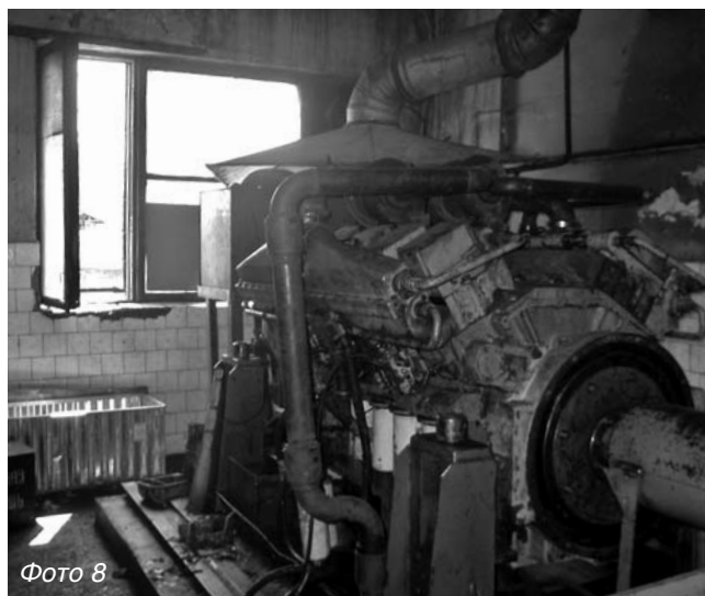
Фото 6-8. Стенд для обкатки двигателей.
