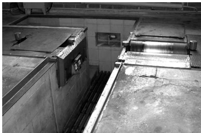
Фото 7. Барабанный стенд, измеряющий величину усилия увода колес.
