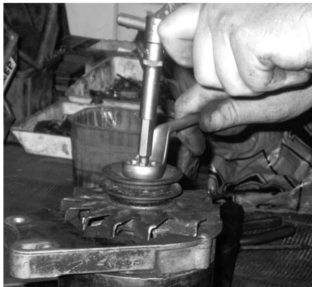
Фото 10. В валу генератора имеется технологическая выемка для откручивания гайки шкива.
