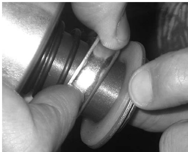
Фото 7. Белый фторопласт фирменного бендикса нетрудно отличить от черного текстолита на подделке.
