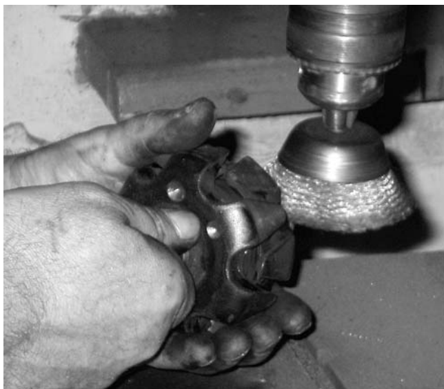
Фото 11. Механическая очистка ротора генератора.
