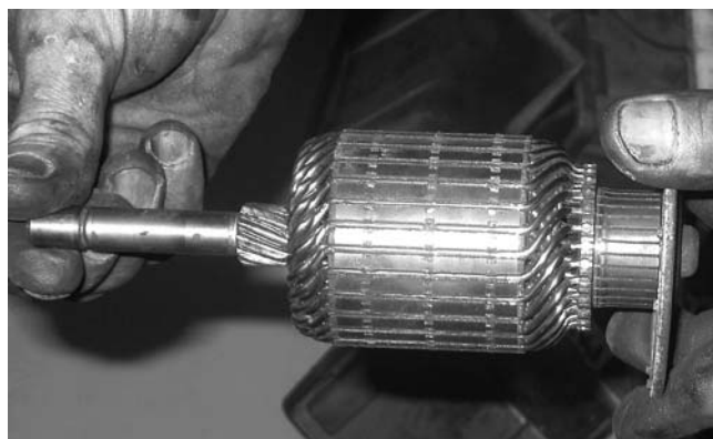
Фото 5 и 6. На роторе и статоре видны задиры, которые, впрочем, не привели к неисправности стартера.
