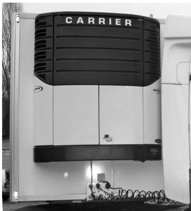
Фото 2. Холодильная установка Carrier
