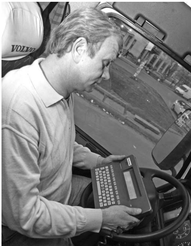
Система Euteltracs обеспечивает двухстороннюю текстовую связь между водителем и диспетчером.
