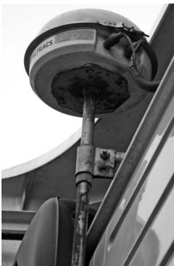
Антенна системы Euteltracs, как правило, монтируется на задней стенке кабины автомобиля.
