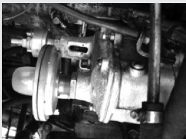
Установка МУЗД и КПС на ТНВД газодизеля
