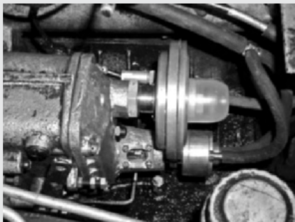
Установка МУЗД и КПС на ТНВД газодизеля
