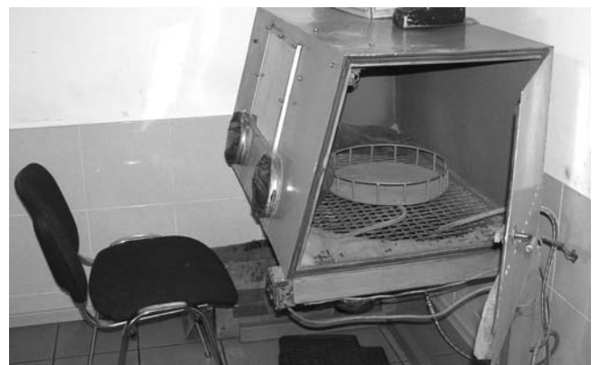
Здесь производится пескоструйная обработка деталей.
