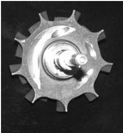
На турбинной крыльчатке видны выборки металла при балансировке.
