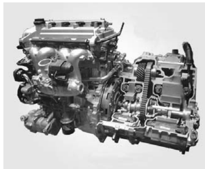
Рис. 1. Сложная компоновка гибридной силовой установки Toyota Prius.
