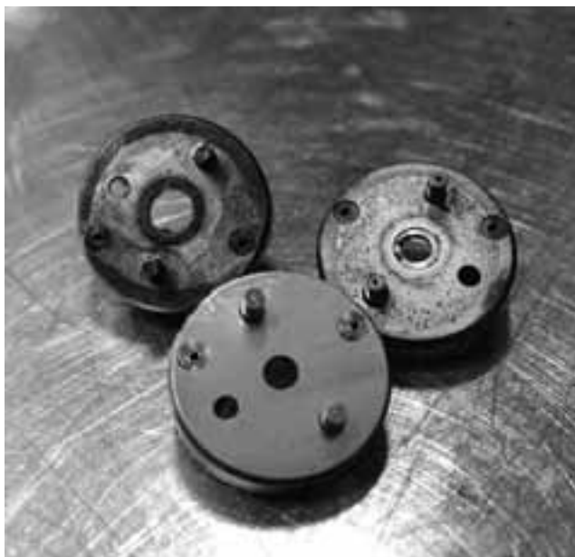
Фото 7. Это одна и та же проставочная шайба. Впереди – новая. У расположенной справа детали видна выработка по упорной плоскости (вокруг отверстия), тогда как у расположенной слева отверстие разбито полностью.
