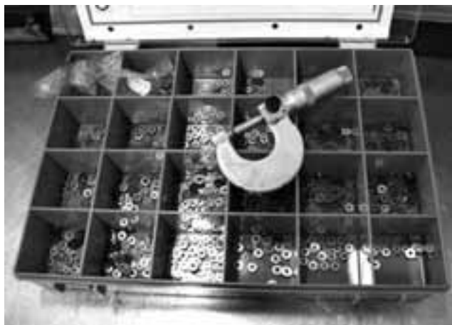
Фото 8. В специализированных сервисах наборы регулировочных шайб с различными диаметрами предназначены «на все случаи жизни». Причем толщина шайб в таких наборах выполнена ступенчато, с шагом в 0,05 мм.
