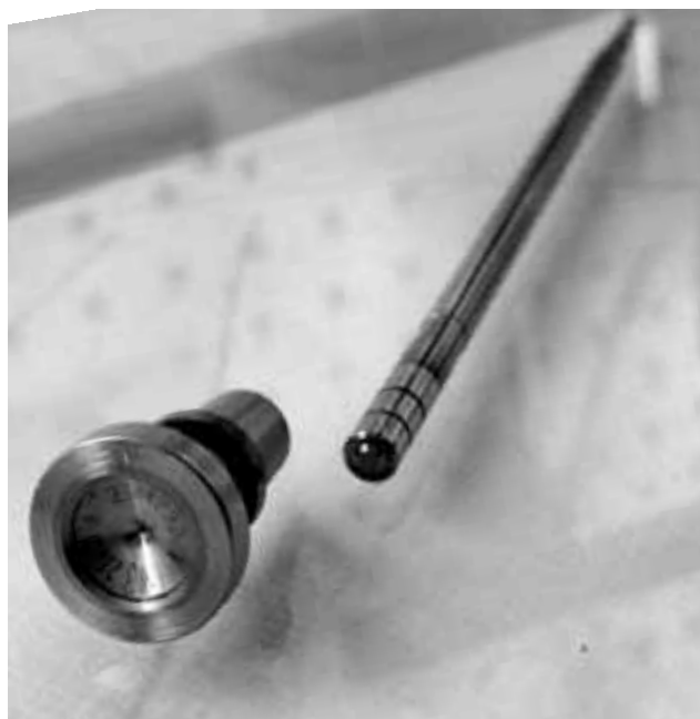
Фото 10. Детали форсунок системы Common Rail восстанавливаются с применением специальных технологий: напыления, шлифовки и пр.
