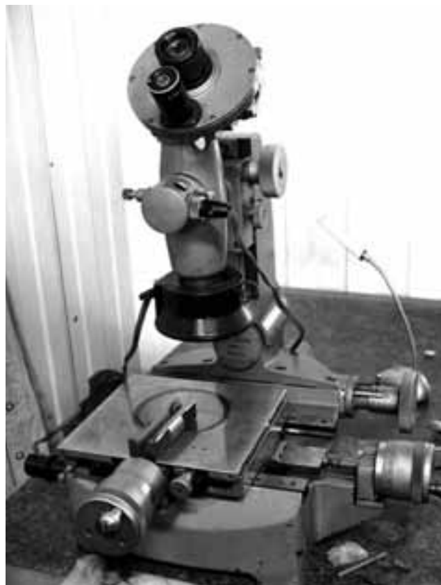
Фото 5. Инструментальный микроскоп применяется для проверки угла, чистоты обработанной поверхности и других параметров.
