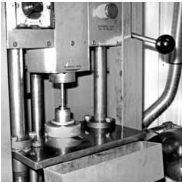
Фото 4. Так шлифуется внутренний конус корпуса распылителя, седла клапана и других деталей.
