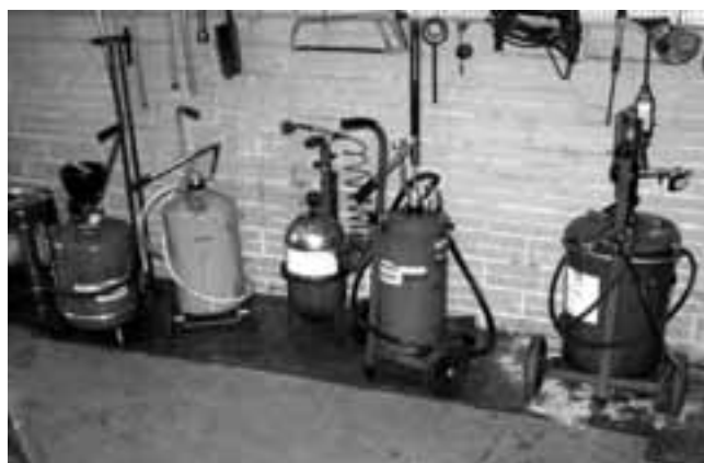
Для каждого типа технических жидкостей на «Iveco сервис» используется соответствующее оборудование.
