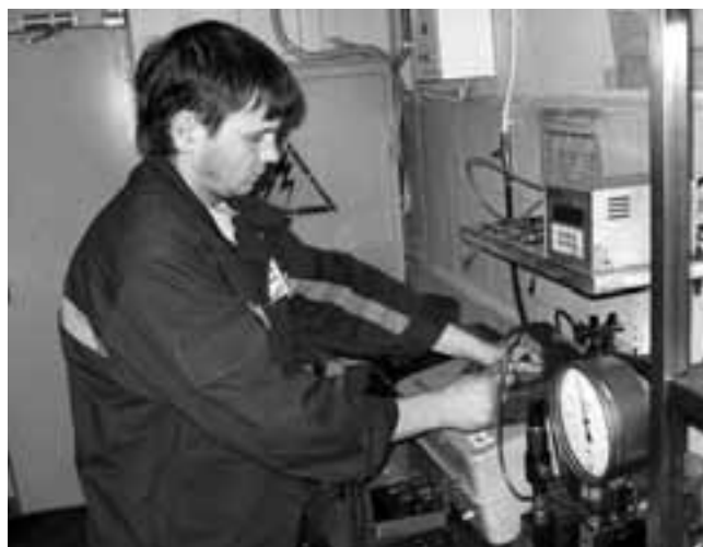
Фото 2. Проверка и регулировка форсунки с механическим управлением проводится на испытательном стенде EPS-100.
