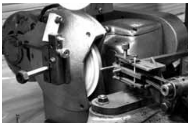
Фото 3. Здесь производится шлифовка конуса иглы под заданным углом. На этом же станке алмазом «выводится» угол бор-штанги, применяемой для шлифовки внутреннего конуса.
