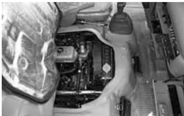
Подняв пассажирское сидение и открыв крышку моторного отсека, получаем довольно удобный доступ к двигателю.
