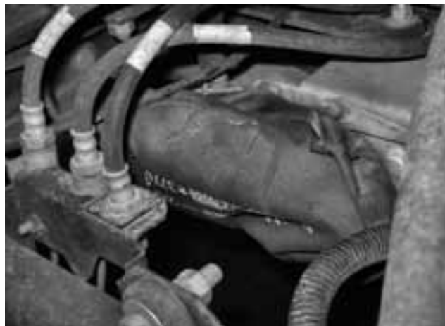
Соленоид, управляющий работой отсекаателя топлива, «запирался» в гидроизолирующий мешок на передней балке рамы.
