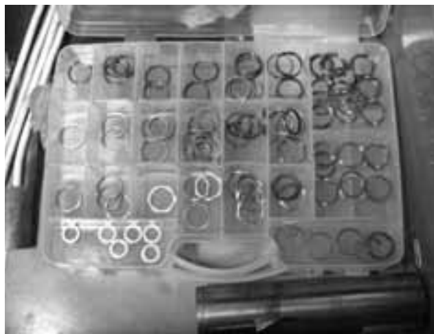
Фото 9. Такие регулировочные шайбы применяются в форсунках системы Common Rail.
