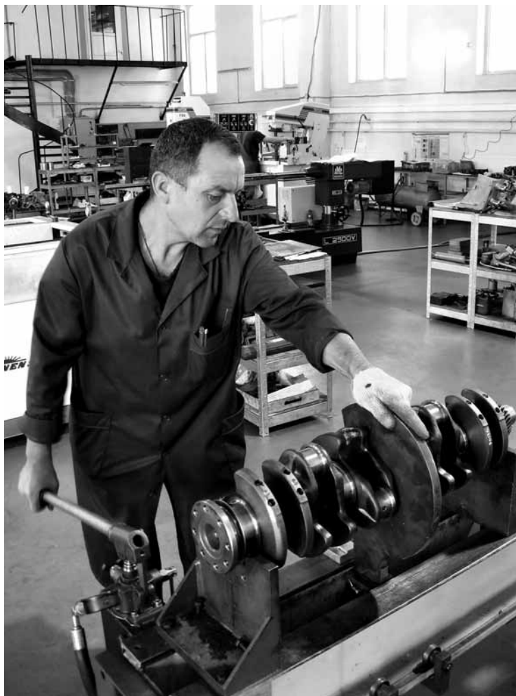
Фото 6. Правка коленчатых валов производится на современном гидравлическом оборудовании с нагреванием и постоянным контролем параметров.
