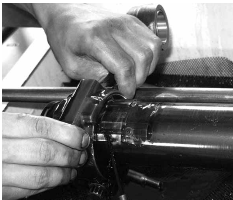
Фото 5. Как и многие другие, отверстия головок шатуна доводятся путем хонингования.
