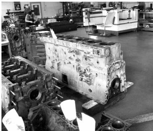
Фото 9. Иногда блоки цилиндров достигают размеров небольшого станка, как этот Komatsu S6D155-4.
