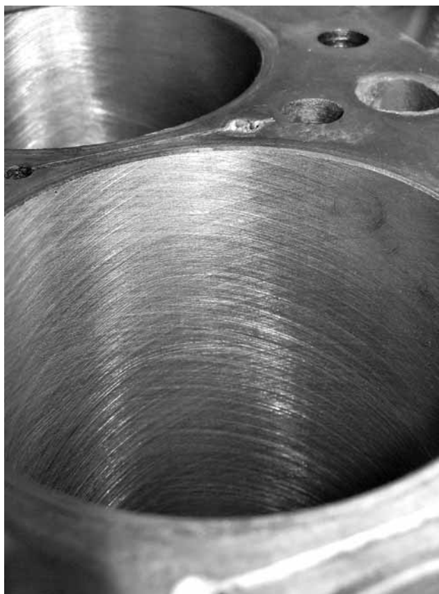
Фото 1. Во время хонингования наносится специальная сетка, позволяющая удерживать максимальное количество моторного масла на стенках цилиндра.
