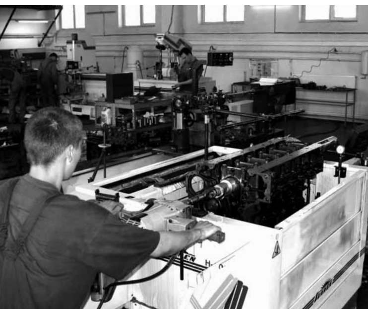
Фото 4. Хонингованием достигается точность диаметра и заданный класс чистоты отверстий под коренные вкладыши.
