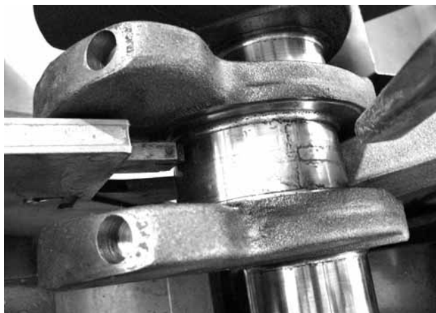
Фото 11. Во избежание прогиба коленчатого вала и его вибрации во время шлифовки применяют поддерживающий люнет.
