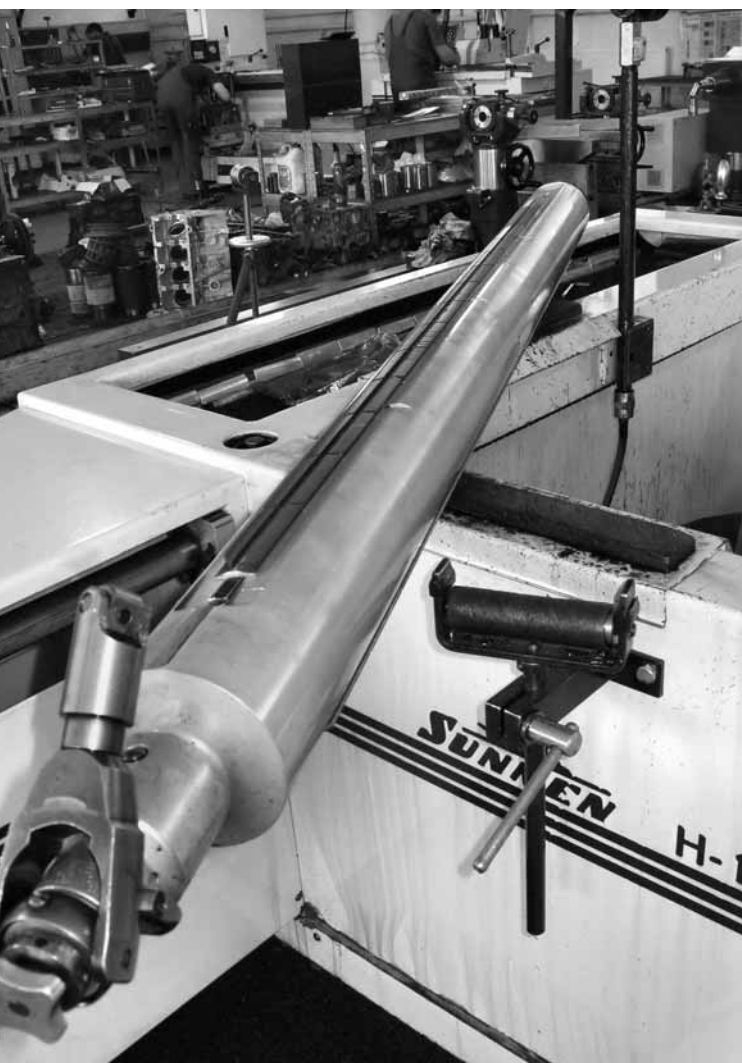
Фото 3. Хон, применяемый для хонингования пастелей коленчатого вала.
