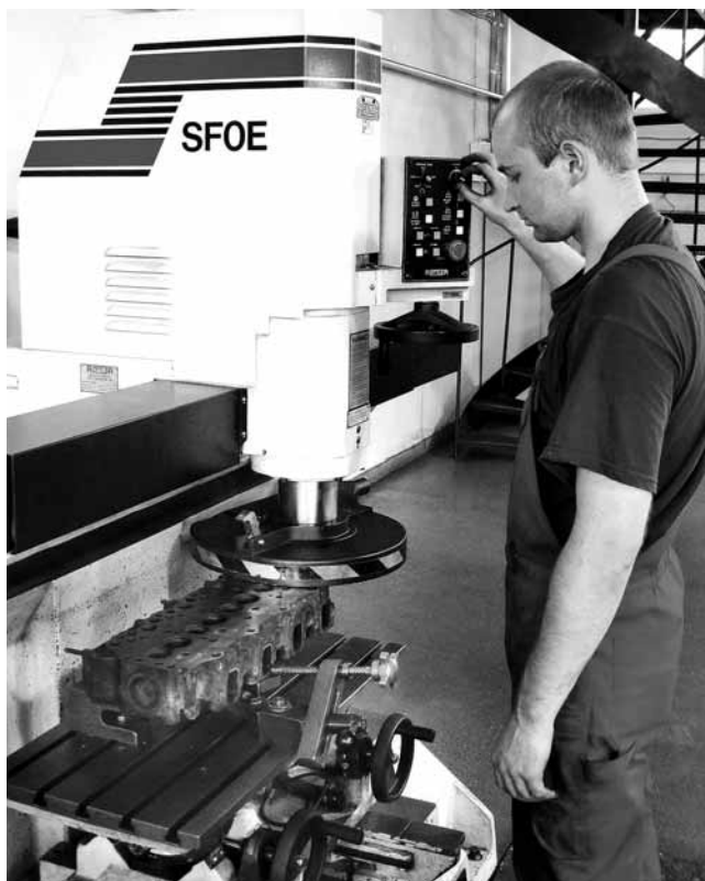
Фото 3. Фрезерование прилегающей плоскости головки блока цилиндров.
