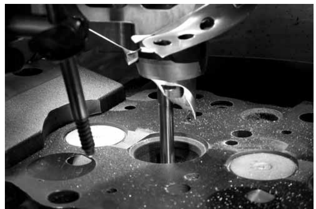
Фото 6. Обработка седла клапана производится трехгранными твердосплавными резцами, позволяющими получить высокое качество обработки, невзирая на твердость металла. Штанга в центре базирует резцовую головку по направляющей втулке клапана. Датчик слева дает возможность выдерживать заданную глубину обработки на всех седлах.
