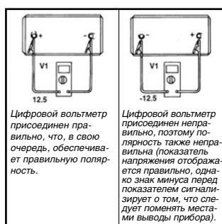
Рис. 3. Результаты измерения напряжения в условиях правильной и неправильной полярности.
