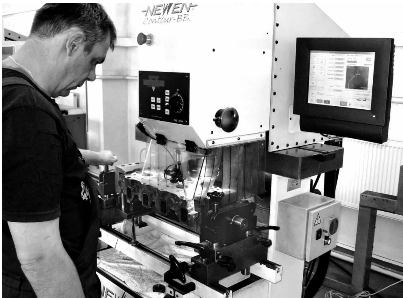
Фото 3. Фрезерование прилегающей плоскости головки блока цилиндров.
