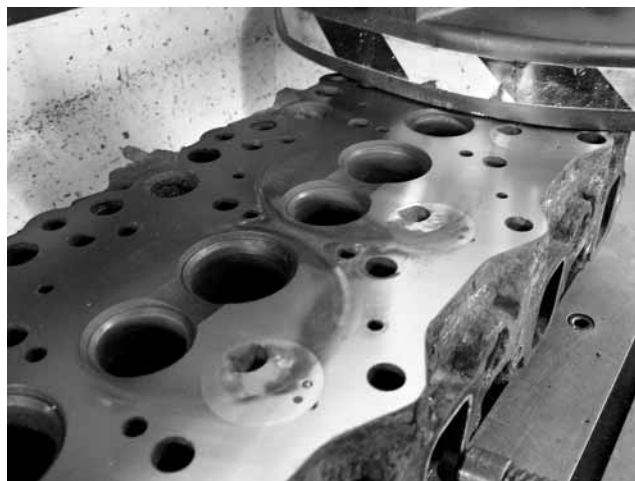
Фото 1. Процесс обработки привалочных плоскостей, как и любая технологическая операция обработки деталей, производится в несколько приемов и разделяется на черновую и чистовую обработку. Так как при каждой операции снимается определенный слой металла, специалисту хорошо видна глубина деформации по еще необработанным участкам. На снимке – процесс фрезерования. Несмотря на то что черновая обработка уже произведена, еще видны углубления (темные пятна), которые дофрезеруются при последующем прохождении режущего инструмента.
