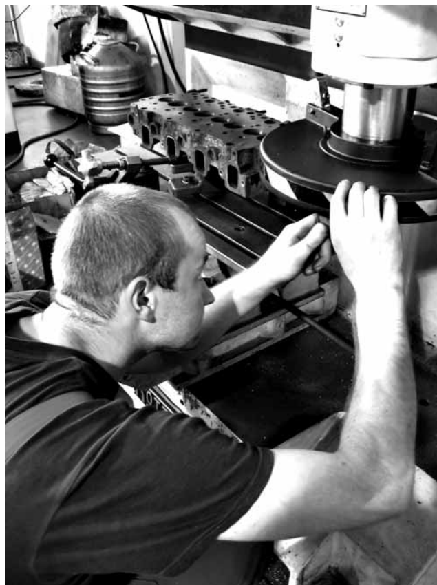
Фото 2. Для получения определенного класса чистоты перед окончательной чистовой обработкой устанавливается резец с неизношенной режущей кромкой. В данном случае (при использовании круглых резцов) он просто проворачивается.
