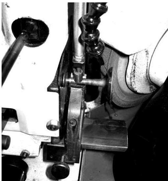
Фот 8. Высокоточное оборудование позволяет произвести обработку рабочей фаски клапана, не требующей последующего притирания клапанов к седлу.
