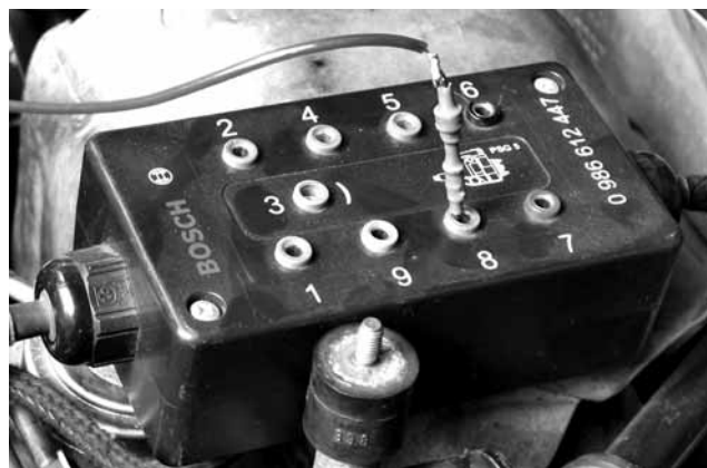
Фото 3. Самым рациональным, однако не совсем дешевым способом устранения проблемы труднодоступности двигателя при диагностике является применение выносного контактного блока — так называемого адаптера.
