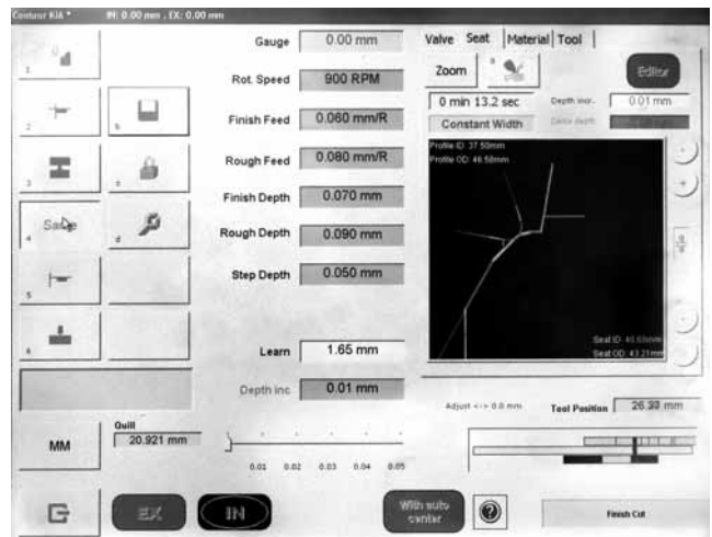
Фото 5. На сенсорном экране станка задаются все необходимые параметры обработки, в том числе и чертеж профиля седла. Здесь же показывается и процесс обработки.
