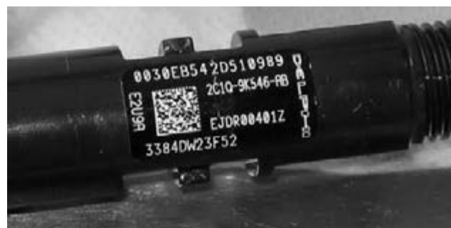
Фото 11. Каждая форсунка имеет свой код, характеризующий ее параметры.
