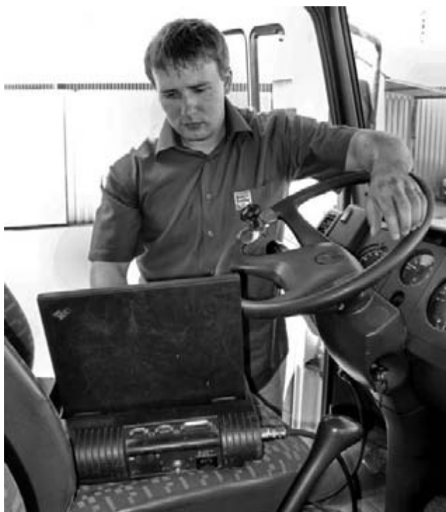
Фото 9. Диагностика автомобиля с помощью дилерского прибора Star Diagnostik.
