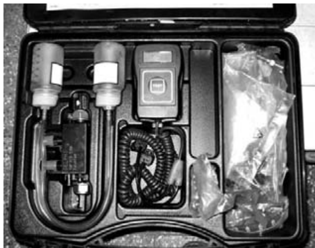
Фото 1-2. Проверка системы Common Rail механическим путем.
