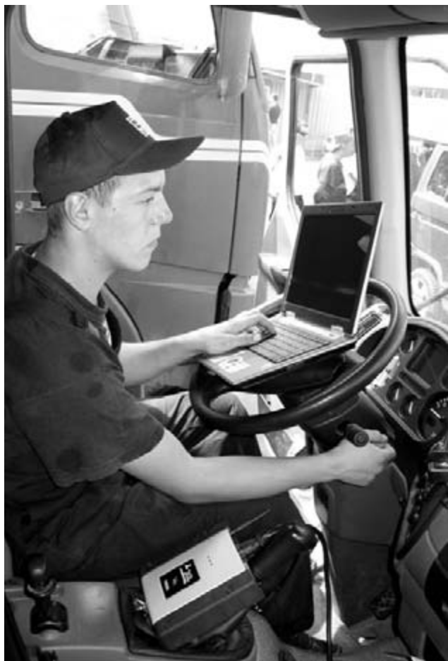
Фото 13. Диагностика с помощью универсального прибора «Навигатор».
