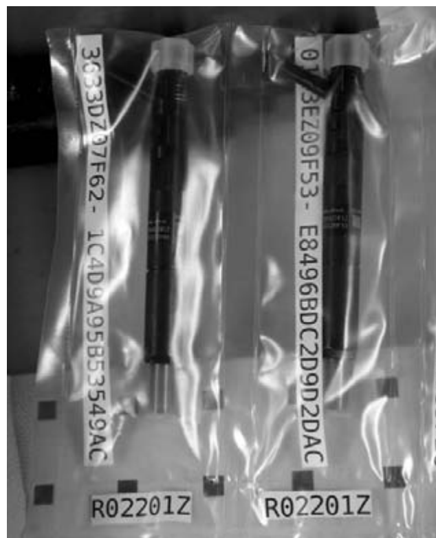
Фото 12. После сборки-разборки параметры форсунок обязательно изменяются, а номер присваивается с помощью стенда.
