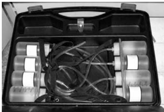
Фото 1-2. Проверка системы Common Rail механическим путем.
