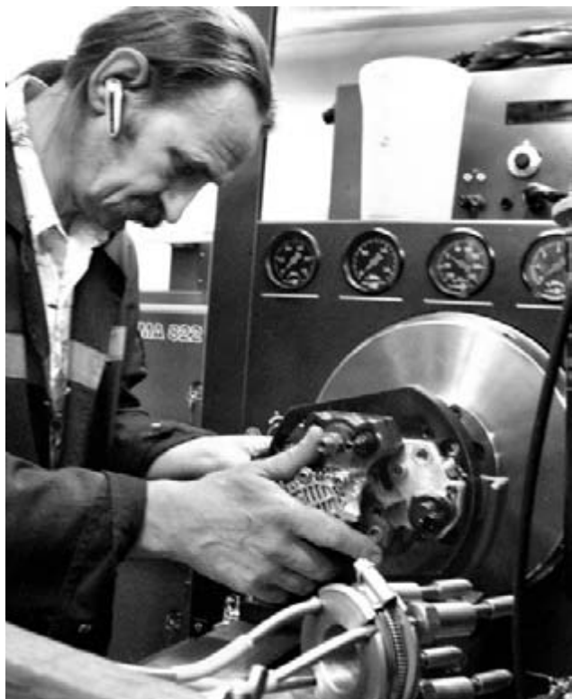
Фото 14. Сергей Ковпак устанавливает насос на стенд, подсоединяет патрубки и электрические провода.
