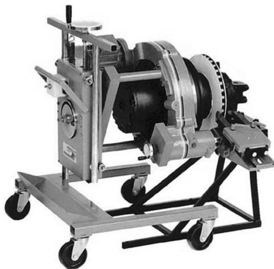
Рис. 3. Аппарат для проточки тормозного диска.
