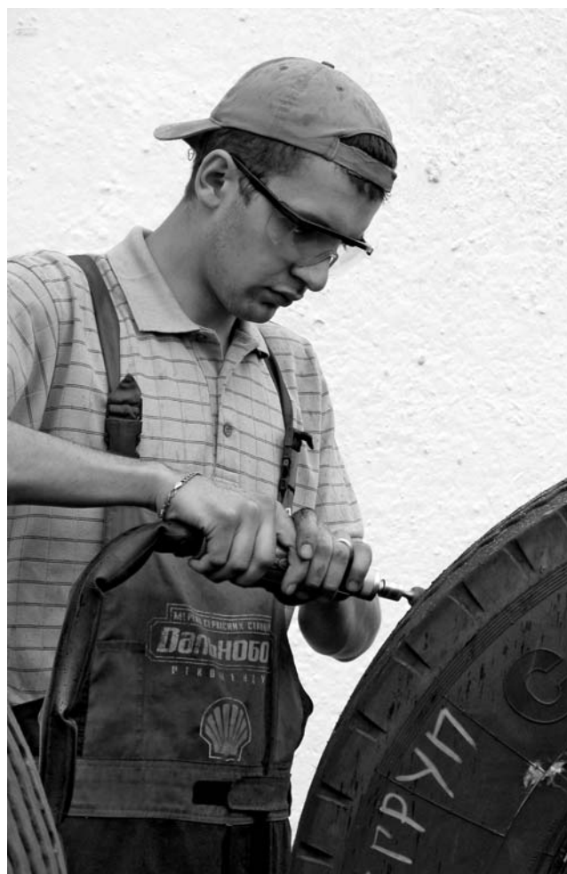
Особо трудоемким и ответственным был ремонт грузовой автошины по двухэтапной технологии с применением термопресса.
