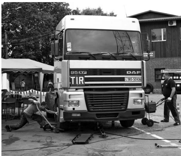
Комплекс работ по замене колес одной оси транспортного средства в аварийной ситуации.
