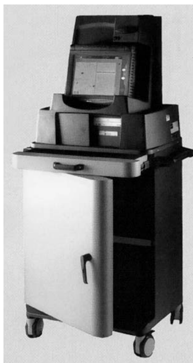
Рис. 7. Базовая станция и тестер, установленные на мобильную лабораторную тележку.
