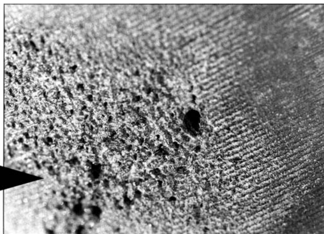
Фото 1 а. Результаты кавитационной эрозии (формирования глубокой точечной коррозии) отчетливо видны при увеличении.
