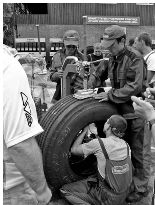
Вулканизация места повреждения.
