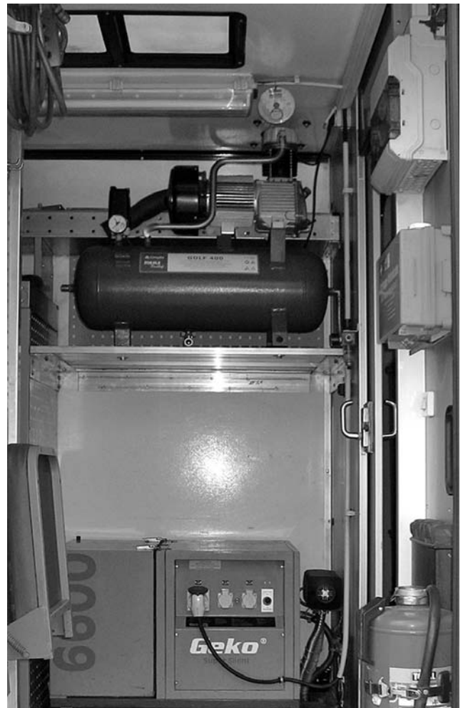
Автомобиль мобильного сервиса оснащен всем необходимым: генератором на 380/220 В, компрессором, портативным компьютером для проведения диагностики и т. д.
