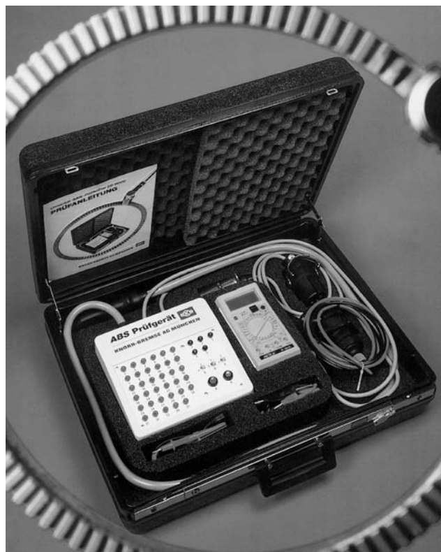
Рис. 6. Диагностический аппарат типа ZB9031-2 в мобильном исполнении.
