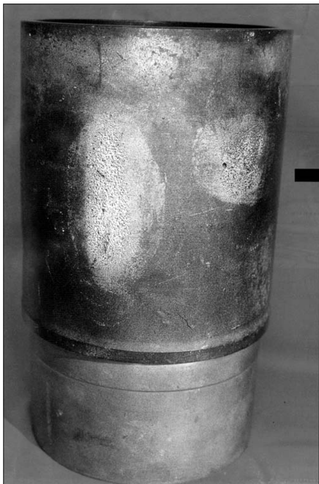
Фото 1. Влажная гильза цилиндра под воздействием «язвенной коррозии» или кавитационной эрозии.
