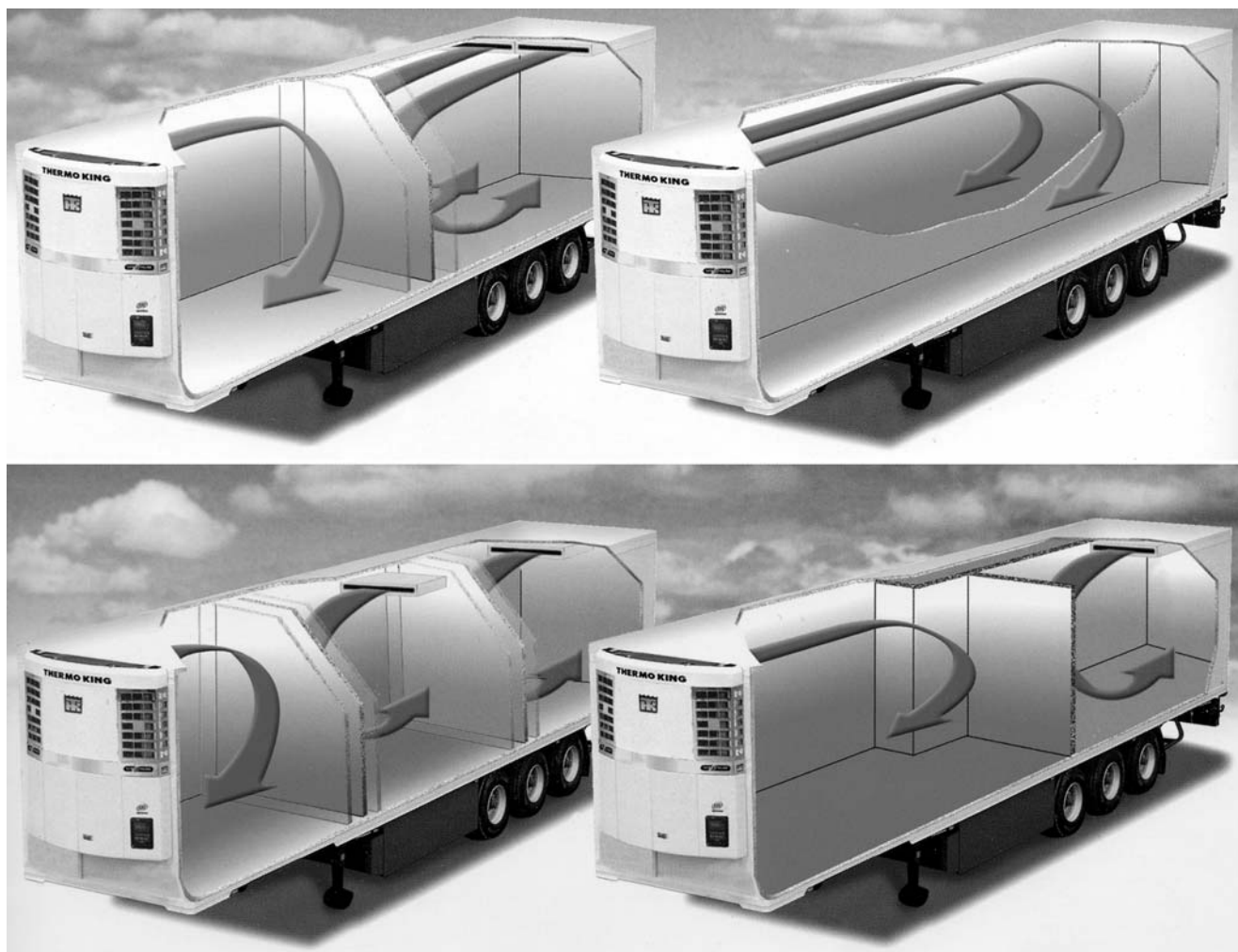
Фото 6. Примеры комбинаций различных температурных зон.
