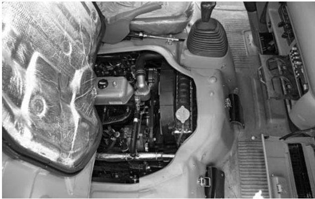
Подняв пассажирское сиденье и открыв крышку моторного отсека, получаем довольно удобный доступ к двигателю.
