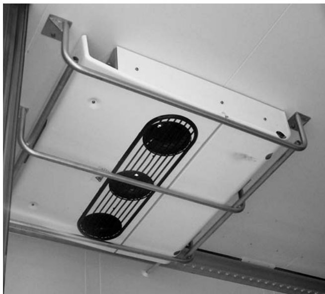
Фото 3 и 4. Чем меньше габариты испарителей, тем больше полезного объема в кузове.
