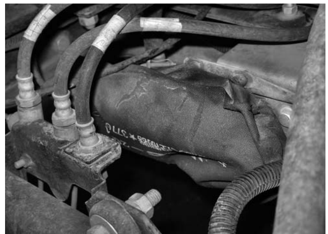
Соленоид, управляющий работой отсекаателя топлива, «застрял» в гидроизолирующий мешок на передней балке рамы.
