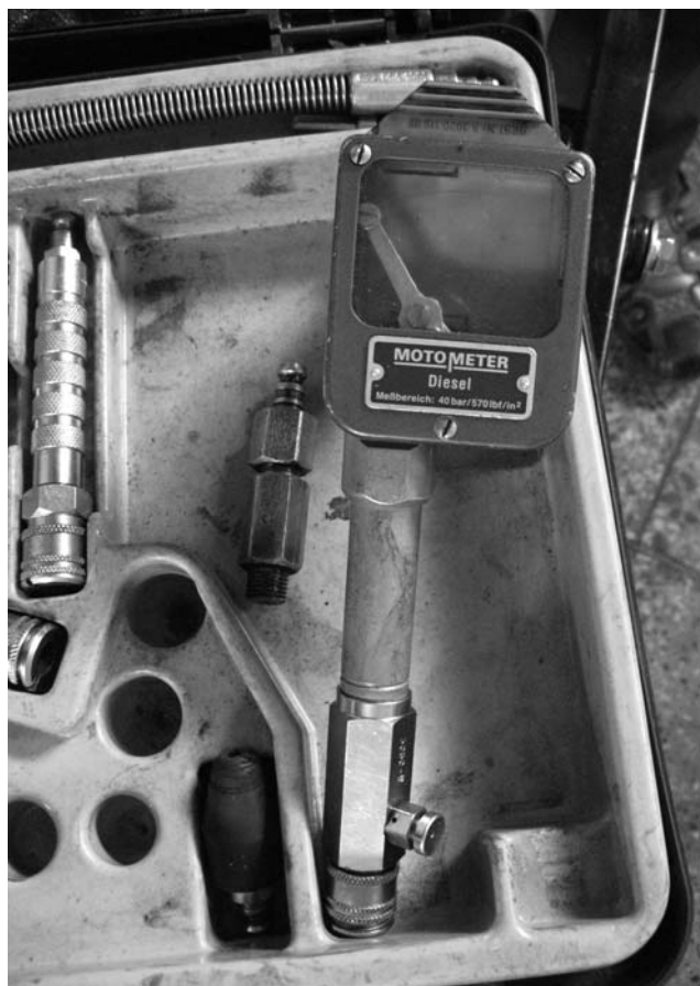
Компрессометр, измеряющий степень сжатия в цилиндре.
