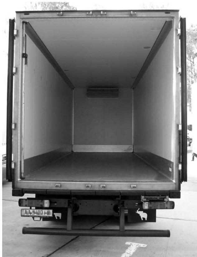
Фото 5. Один из параметров выбора холодильной установки — объем кузова.
