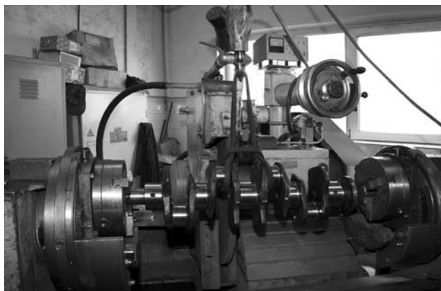
Шлифовка коленвалов выполняется на оборудовании лубненского завода «Коммунар».
