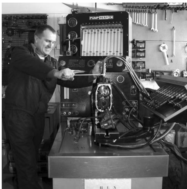
Цех по ремонту топливной аппаратуры всех мастей оснащен стендом для рядных насосов высокого давления (мощность – 16 кВт), а также оборудованием для ремонта и диагностики форсунок, систем Common Rail, насос-форсунок и насосных секций.
