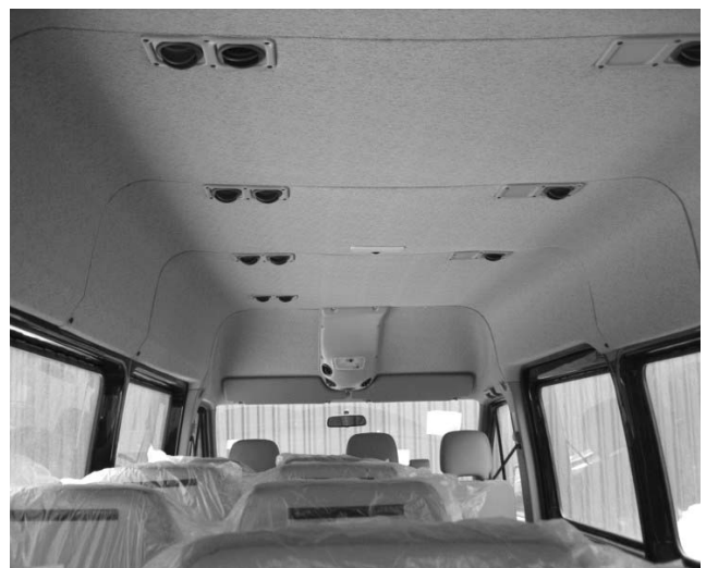
Полученный чистый кондиционированный воздух через отверстия в коробах, проложенных над пассажирами, а также через регулируемые пассажирами выпускные рефлекторы, расположенные над их местами, поступает обратно в салон.
