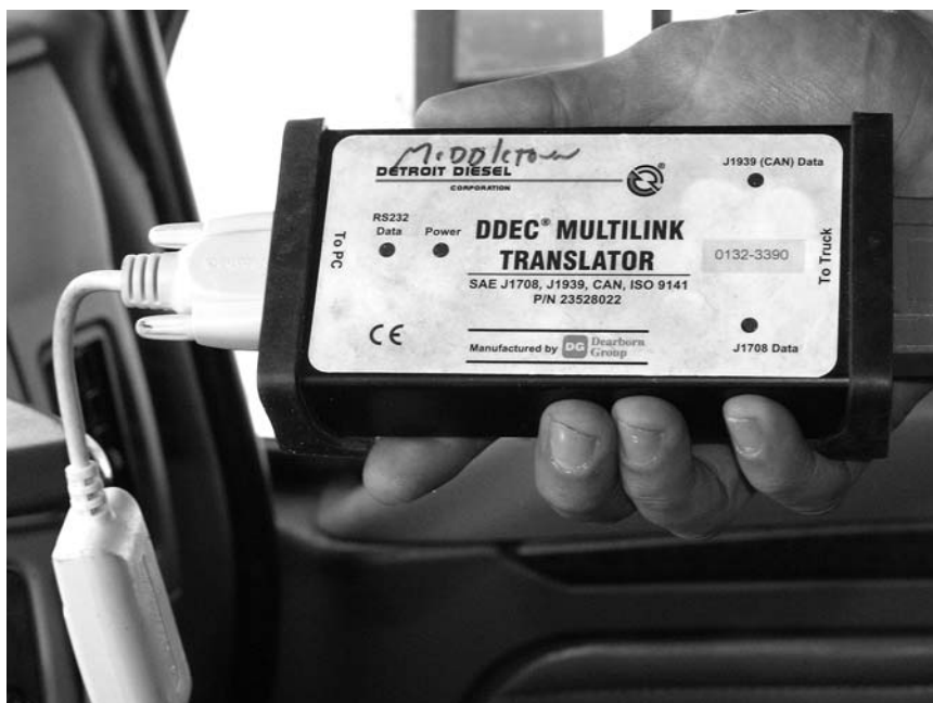
Диагностика американских грузовиков осуществляется с помощью простого адаптера, который подключается к разъему в кабине, а с другой стороны – к ноутбуку.
