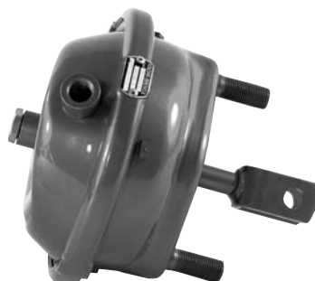
Рис. 19. Элементы привода барабанных тормозов со сварной вилкой.
