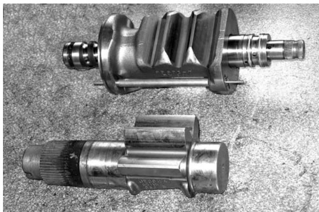
Фото 2. Детали гидроусилителя ZF: рейка-поршень (вверху) и вал рулевой сошки с сектором.
