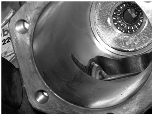
Фото 1. Рабочий цилиндр гидроусилителя ZF. Внутри видно отверстие для сектора рулевой сошки.
